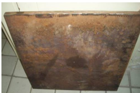
Fotografia 3 - Placa utilizada na Prova de Carga Direta.
