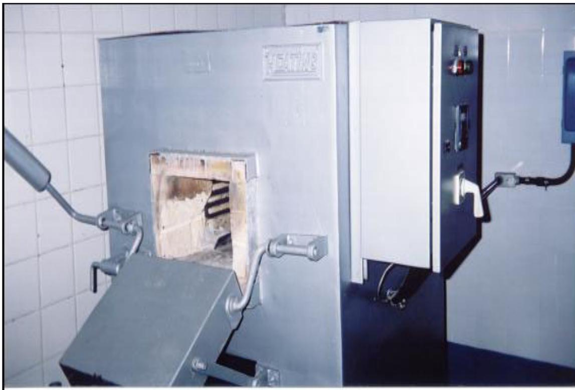
Figura 3.9 Forno elétrico do DEMEC adaptado para decomposição da gipsita.
