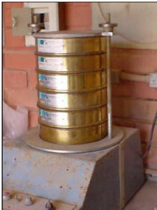
Figura 3.2 – Peneiramento mecânico. Jogo de peneiras calibradas.
