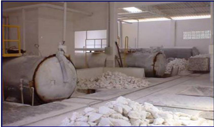
Figura 2.7 – Reatores de calcinação do gesso (obtenção de gesso alfa).
