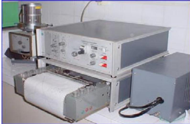
**Figura 3.3** Analisador termogravimétrico – ATD-TG.
