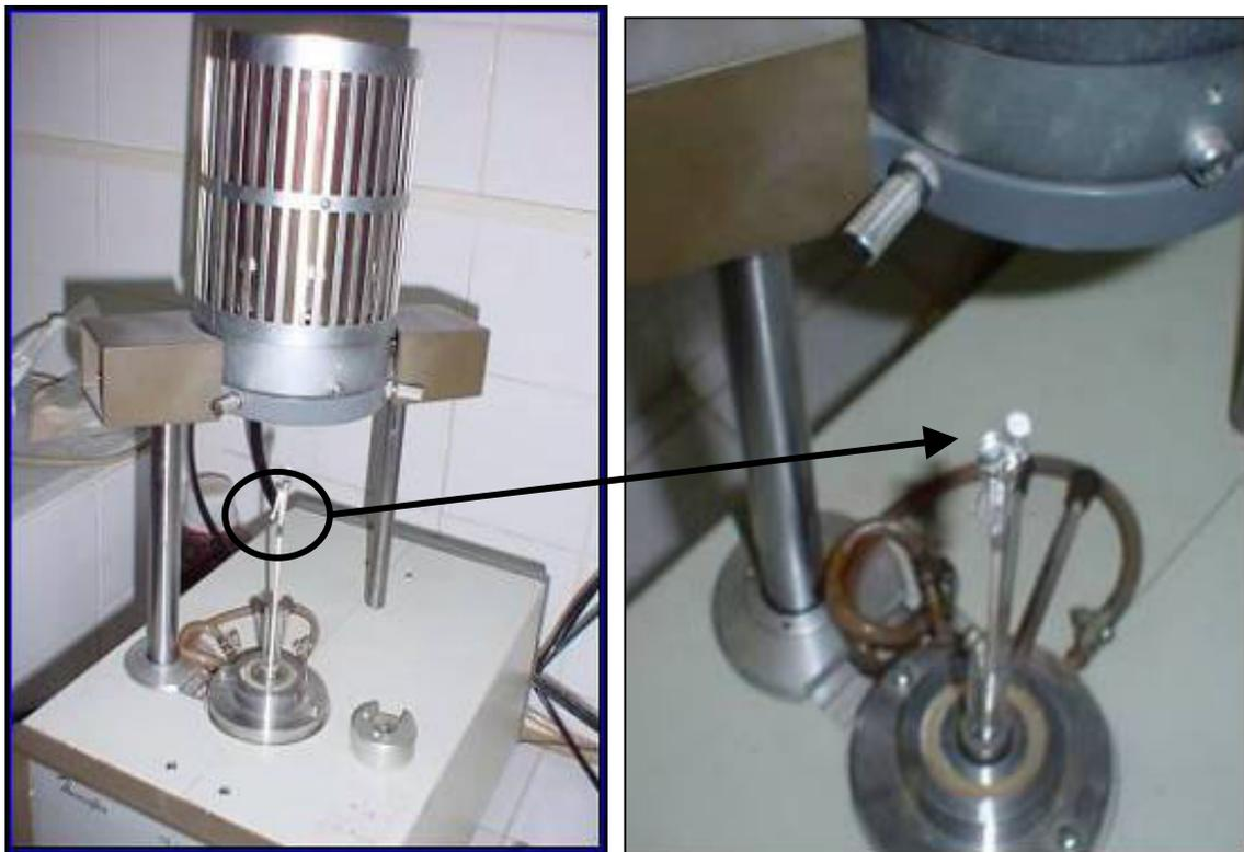
**Figura 3.4** – A: Vista parcial da termobalança; B: Detalhe da posição dos cadinhos.
