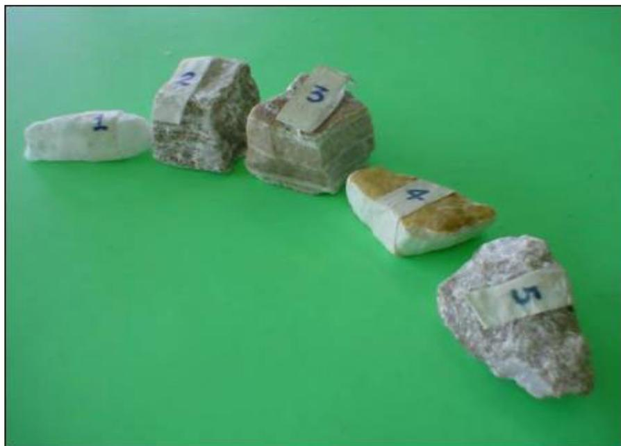
Figura 3.1 – Amostras de gipsita extraídas da região da Chapada do Araripe.
