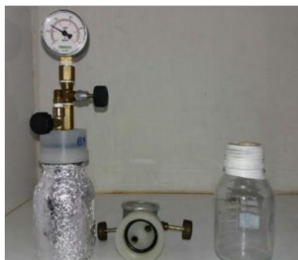
Figura 10 - Biorreator, composto em borossilicato (garrafa), nylon (tampa) e latão (conexões), utilizado no ensaio BMP.
