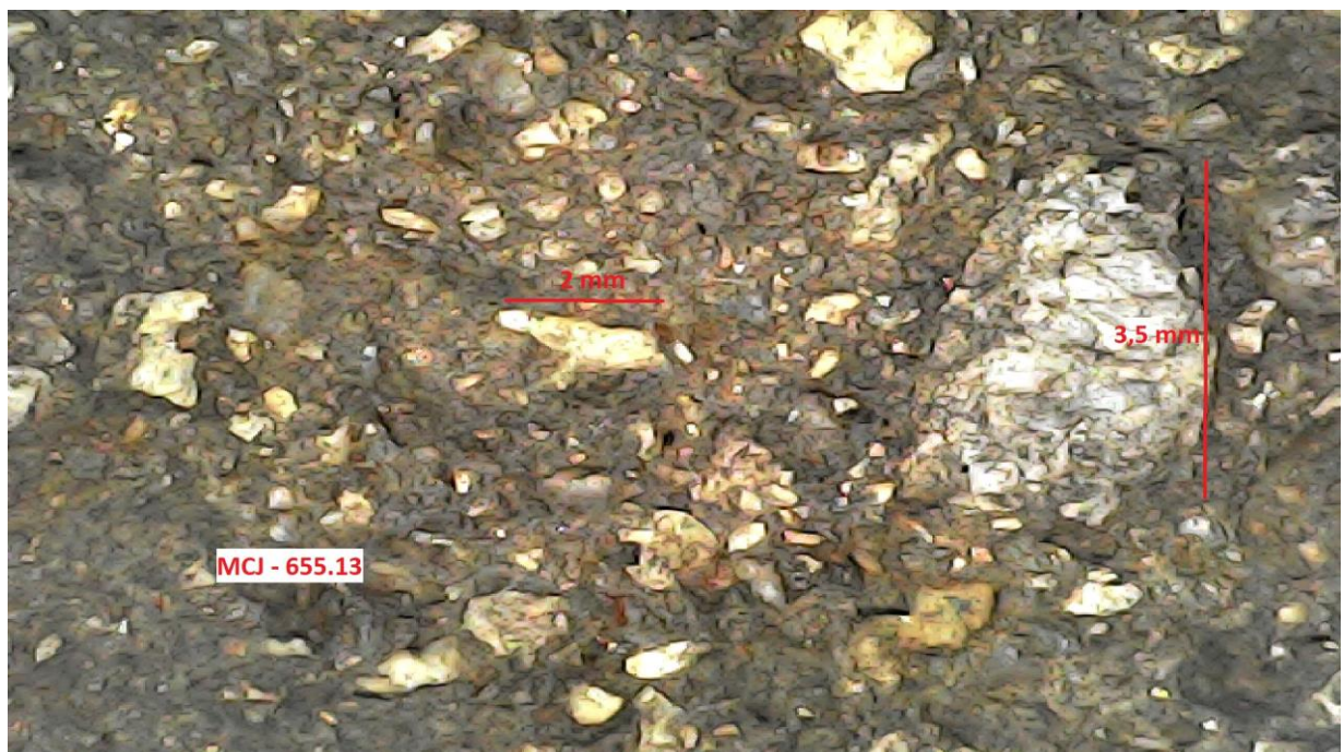
Figura 36: Imagem em microscópio digital ISM – PRO aumentada 30 vezes da pasta 04.
