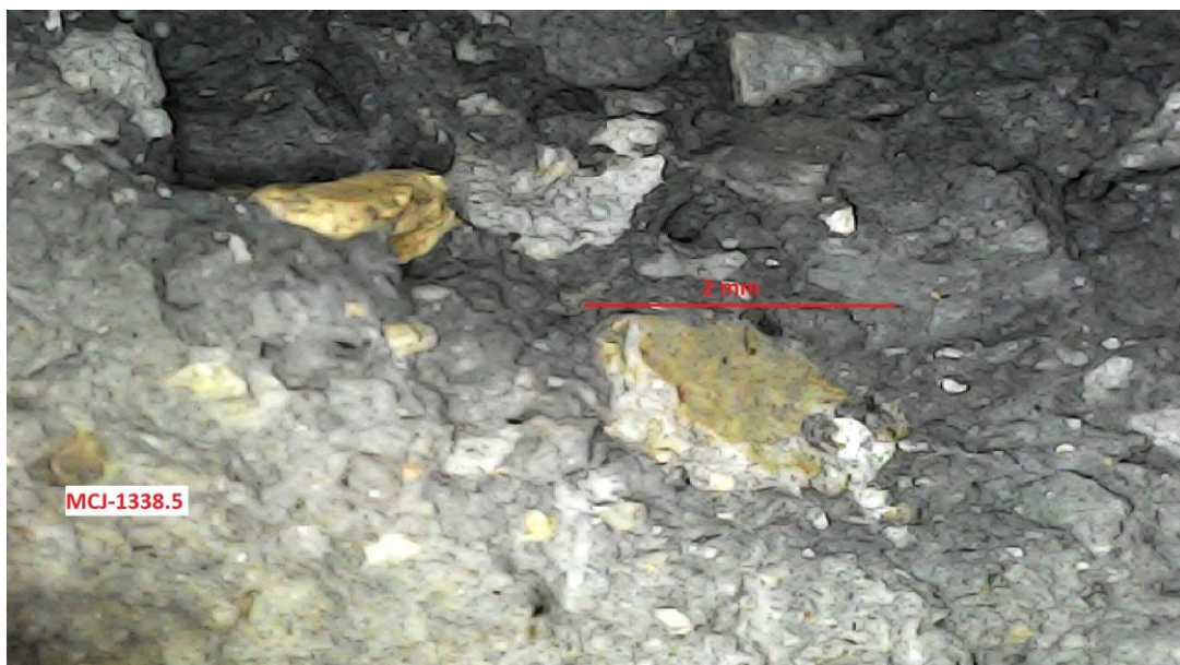
Figura 34: Imagem em microscópio digital ISM – PRO aumentada 30 vezes da pasta 02.
