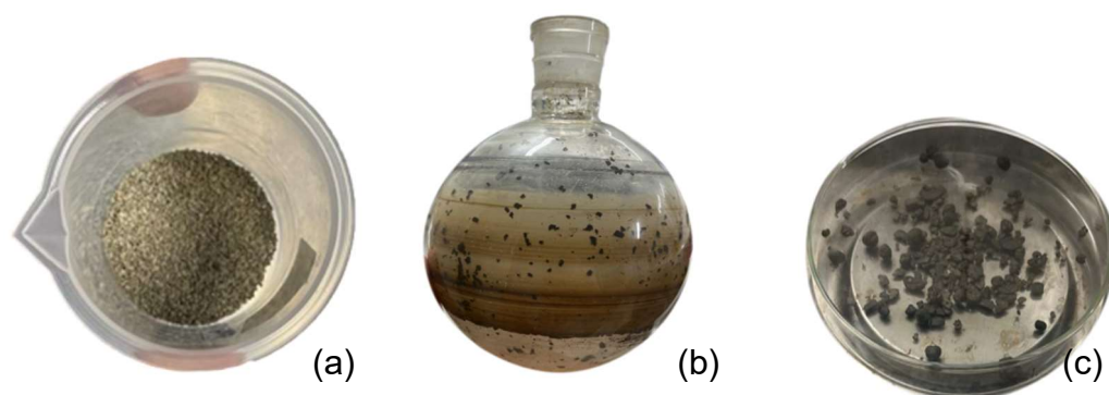
Figura 06. Argila após processo de peneiramento mecânico (a), do AFCI produzido após a rotoevaporação a 70 °C (b) e do AFCI após secagem (c).
