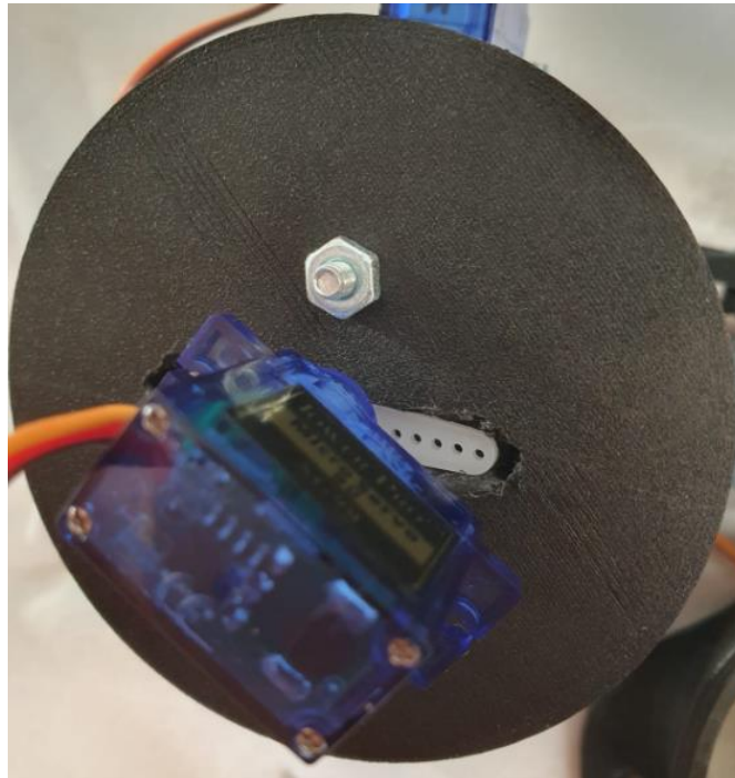
Figura 36. Motor encaixado na base com furo ajustado
