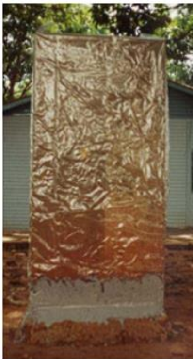
Figura 11 – Pilar envolto pela cinta de borracha com solução alcalina em seu interior.
