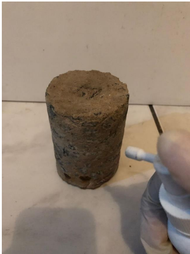
Figura 22 – Método de aplicação de solução alcalina com spray.
