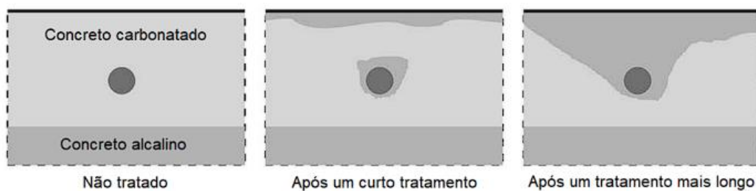
Figura 7 – Evolução da realcalinização eletroquímica da estrutura de concreto armado ao longo do tratamento.
