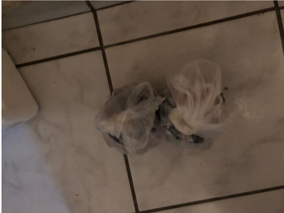
Figura 21 – Método envolvimento das amostras em manta embebida com solução alcalina.
