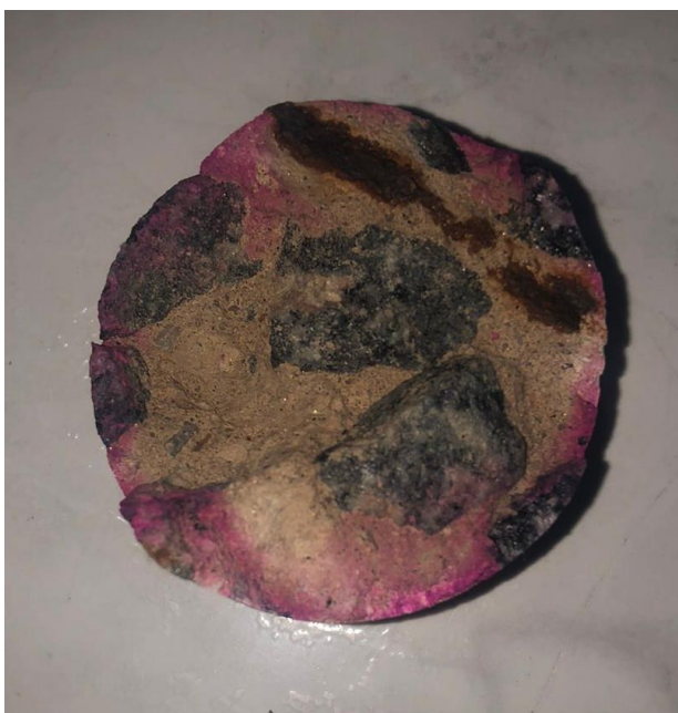
Figura 26 - Final do tratamento de realcalinização método de trincha.
