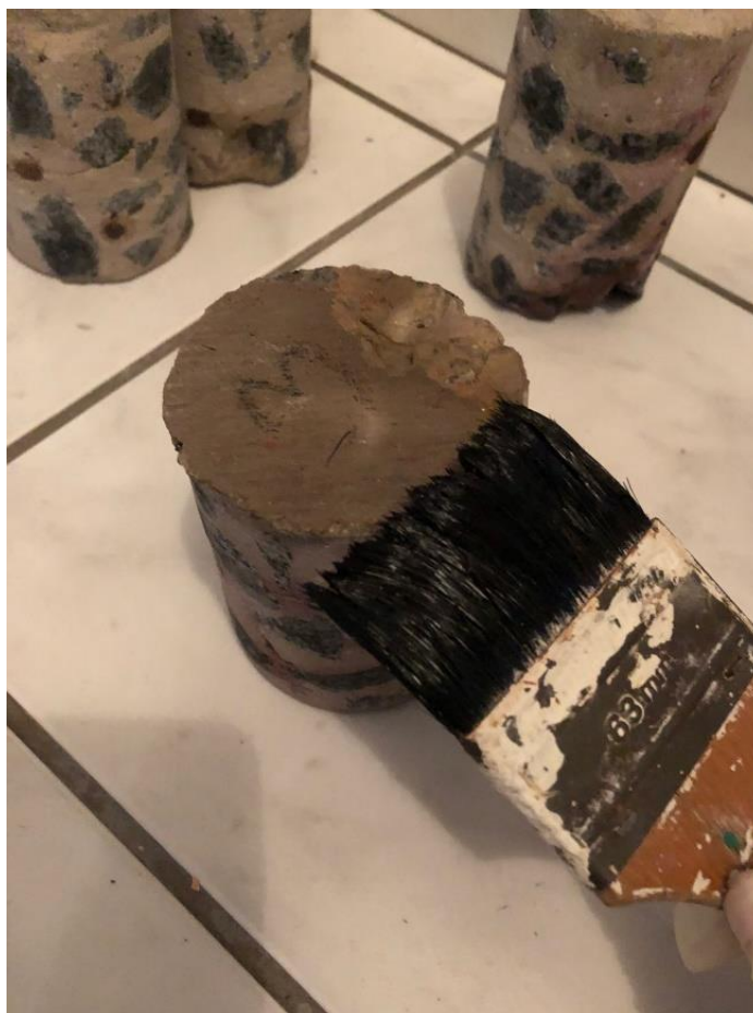
Figura 23 – Método de aplicação de solução alcalina com trincha.
