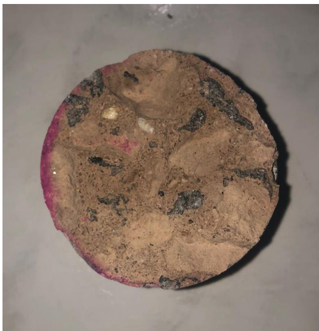
Figura 25 - Final do tratamento de realcalinização método de spray
