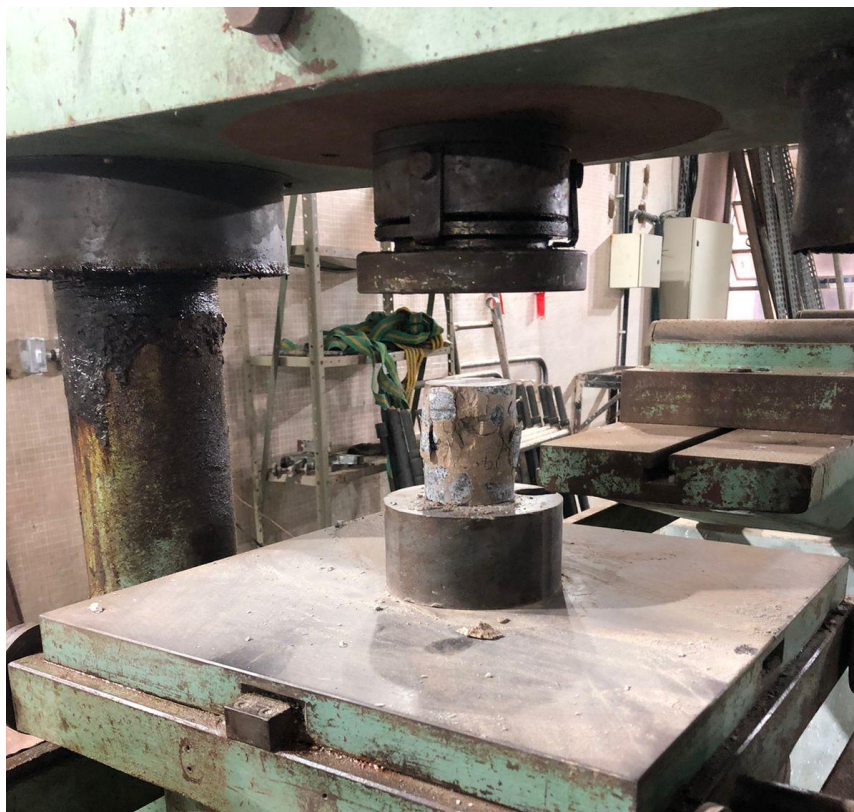
Figura 20 - Ensaio de resistência à compressão
