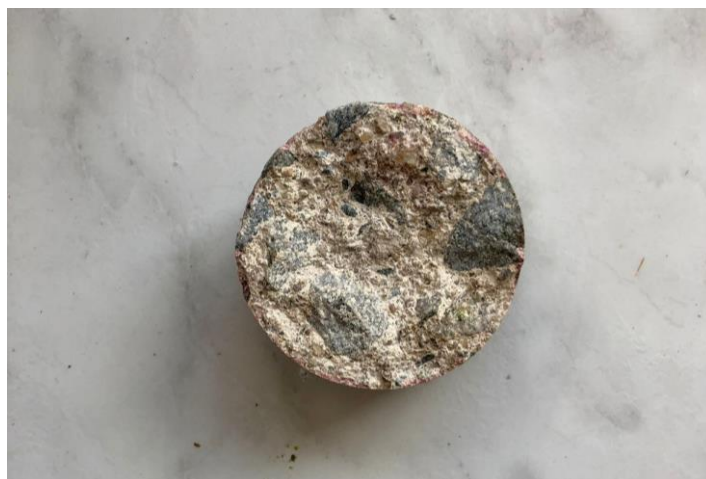
Figura 17 – Corpo de prova fraturado para a medição de carbonatação.
