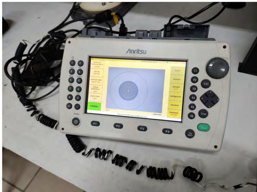
**Figura 3.16:** Refletômetro no domínio do tempo (OTDR) utilizado no trabalho. (Fonte: o autor.)
