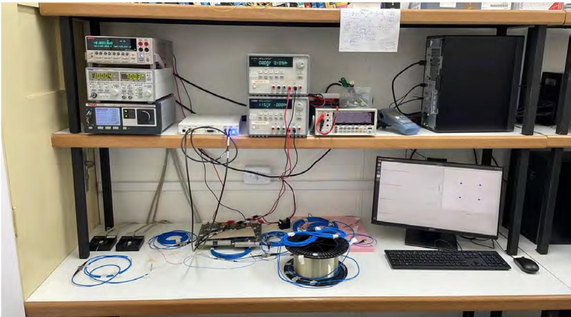
**Figura 3.9:** Imagem frontal do experimento montado em bancada no laboratório de Fotônica, na qual é possível se observar o sistema completo; em especial, destaque para as fontes de tensão e *sourcemeter* utilizados na polarização do modulador externo. (Fonte: o autor.)
