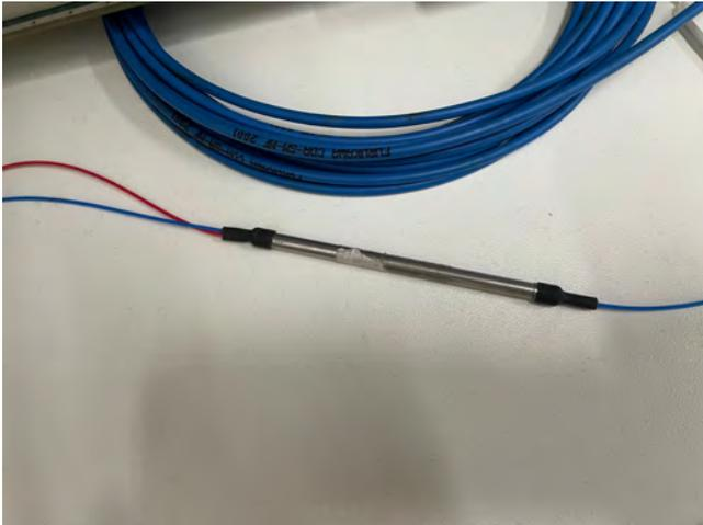
**Figura 3.11:** Multiplexador óptico WDM que recebe os sinais de dados e potência com diferentes comprimentos de onda e realiza a multiplexação na mesma fibra. (Fonte: o autor.)
