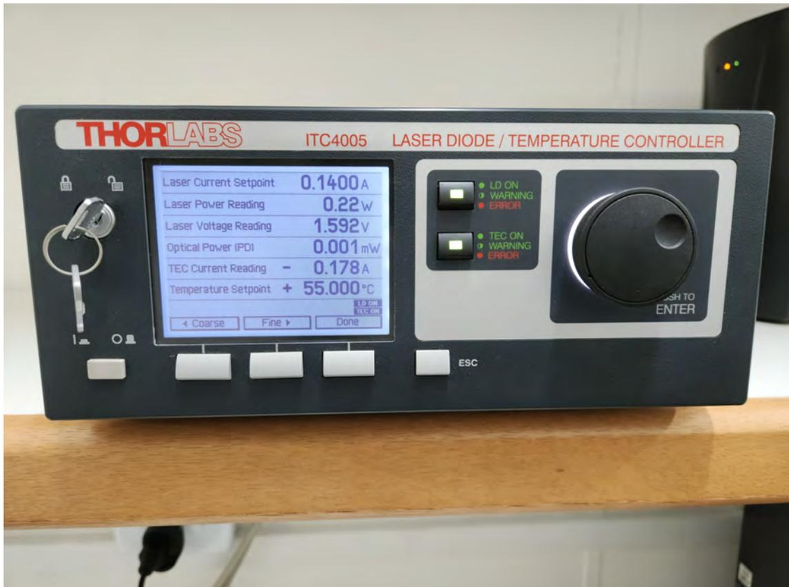
**Figura 3.6:** Controlador de corrente e temperatura utilizado para o ajuste de potência de saída do laser DFB de dados no sistema. (Fonte: o autor.)
