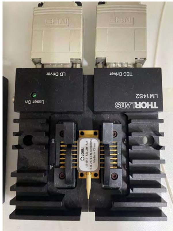
**Figura 3.3:** Laser de alta potência utilizado no trabalho, acomodado numa estrutura *butterfly*. (Fonte: o autor.)
