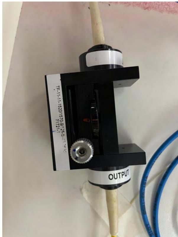
**Figura 3.10:** Filtro sintonizável utilizado no trabalho. (Fonte: o autor.)
