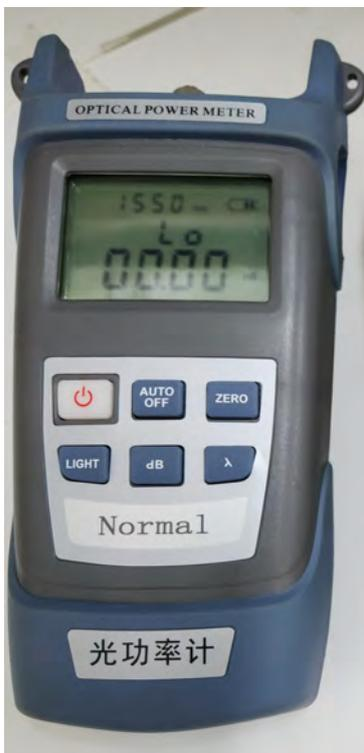
**Figura 3.14:** Medidor de potência óptica utilizado no trabalho. (Fonte: o autor.)
