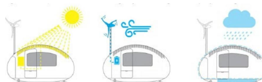
Figura 45 - Esquema dos sistemas de geração de energia e de captação de água da *Ecocapsule*
