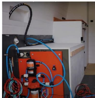
**Figura 37** - Instalação de caixa d'água dentro da motorcasa (interno a um banco/sofá-cama); perde-se espaço de armazenamento, mas garante mais durabilidade e previne o congelamento em locais frios
