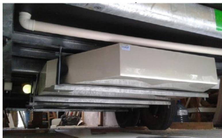
**Figura 36** - A caixa d'água costuma ficar na parte inferior da motorcasa ou do reboque, para evitar o desequilíbrio; uma opção é colocar embaixo do chassi, deixando mais espaço interno livre, mas, caso circule por lugares frios, aumenta o risco da água congelar, podendo romper a caixa ou até mesmo a tubulação inicial
