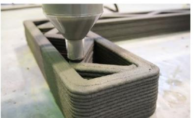
**Figura 48** - Adição do material por meio de camadas de espessura pré-definida, com desenho seguindo o modelo digital
