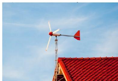
**Figura 33** - Aerogerador cata-vento, com uma "cauda" que funciona como uma biruta, fazendo com que se oriente pela direção do vento
