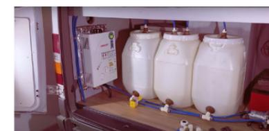
**Figura 39** - Estrutura de reservatório composta por galões separados, também eficientes em prevenir a formação de ondas; algumas pessoas aproveitam o sistema em galões para ter mais controle sobre o consumo de água
