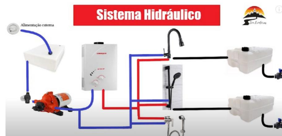
**Figura 40** - Esquema do funcionamento do sistema hidráulico de uma habitação móvel começa com a fonte de abastecimento (externa ou de tratamento interno da água; e depois segue por um registro e bomba que leva a água para todo o sistema; normalmente o aquecimento é realizado ao sair da bomba, por meio de um aquecedor de passagem; e depois segue a água fria e a quente para abastecer os pontos de uso, que contam com um ralo que liga para um reservatório de água cinza ou negra
