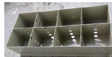
**Figura 38** - Estrutura interna de um reservatório de polipropileno; a parte interna conta com montantes verticais para prevenir a formação de ondas, quando em movimento, que poderiam romper a caixa
