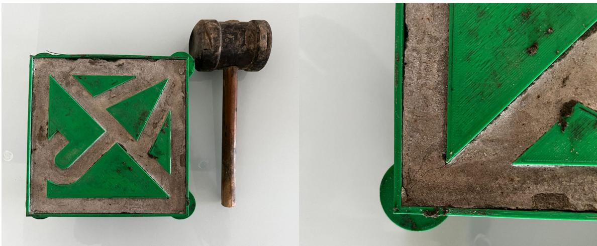
Figuras 56 e 57 – Tentativa de desmolde do cobogó de concreto. Fonte: o Autor.
