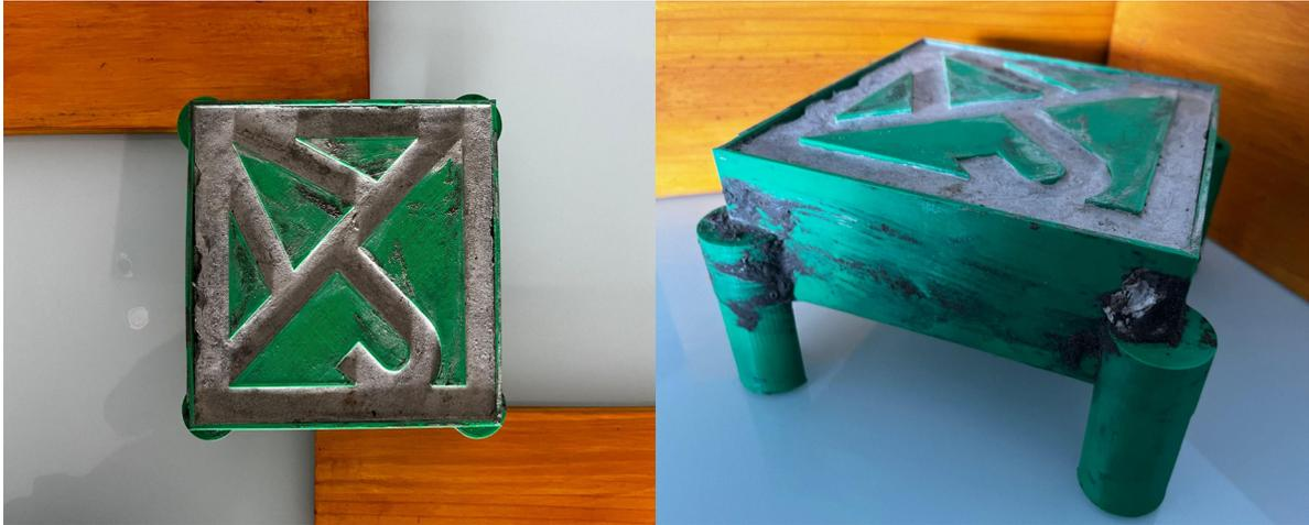
Figuras 54 e 55 – Fôrma preenchida com concreto. Fonte: o Autor.
