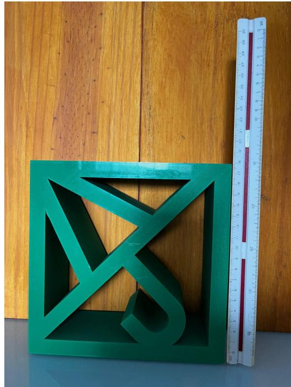
Figura 58 – Impressão de um cobogó em sua forma e tamanho finais. Fonte: o Autor.
