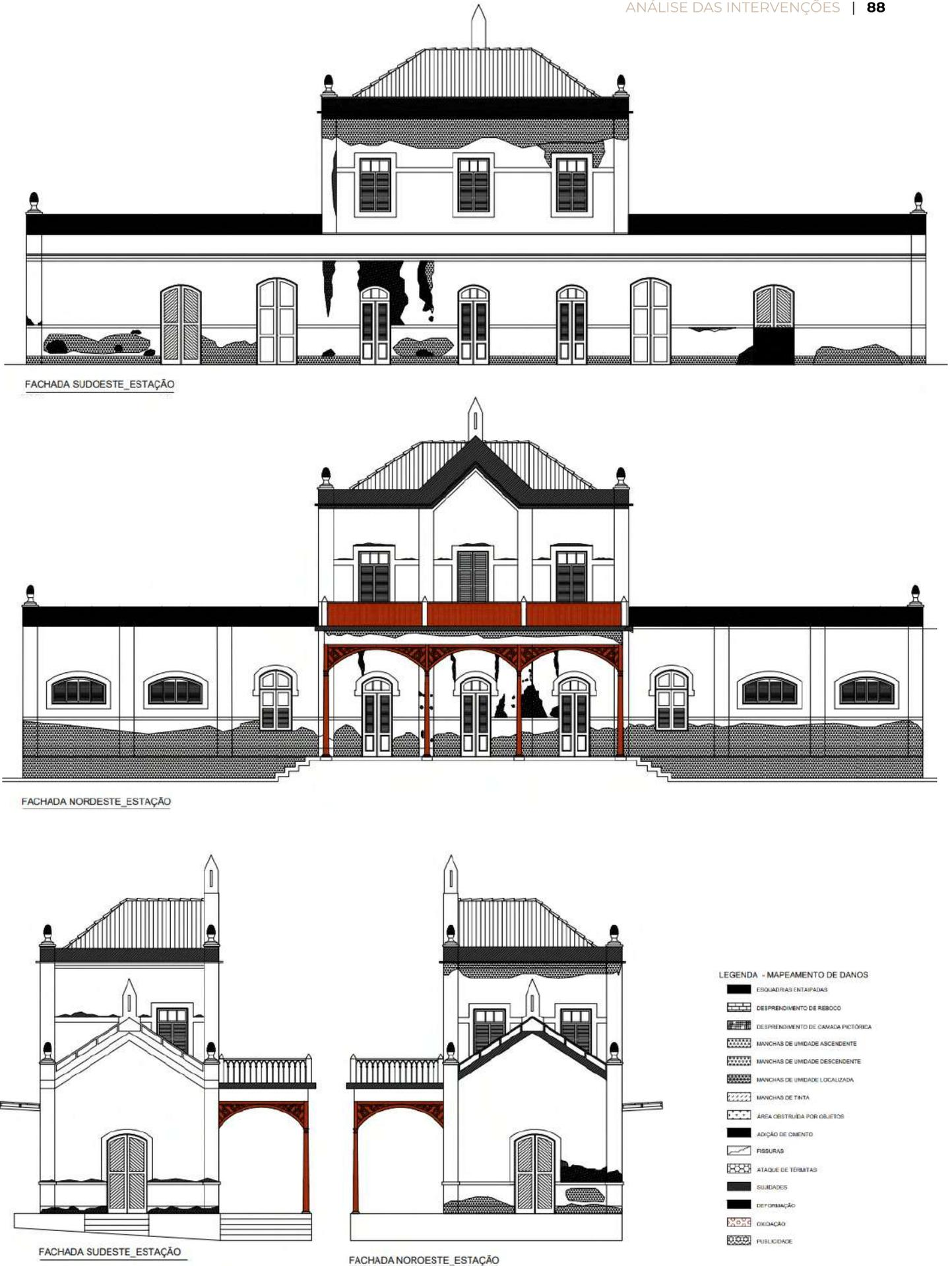
Figura 81: Identificação dos danos nas fachadas da Estação.
