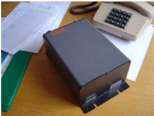
Figura 6.6: Fotos do receptor ASHTECH modelo Z-XII.
