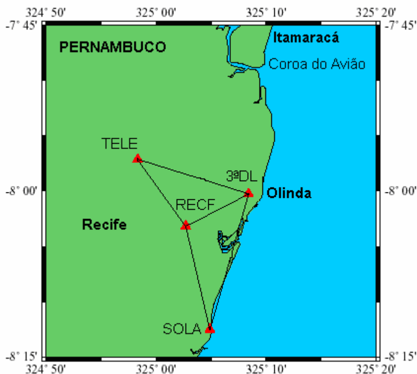
Figura 7.1: Rede de referência GPS instalada na RMR e utilizada no projeto desenvolvido em novembro de 2000.
