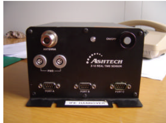
Figura 6.6: Fotos do receptor ASHTECH modelo Z-XII.
