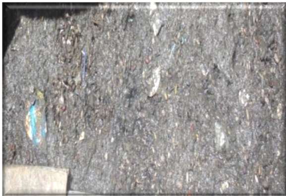
Figura 5.5: Camada de espuma na superfície do reator UASB
