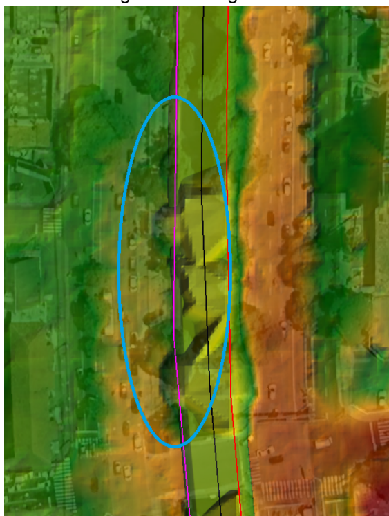
Figura 7 - Erros de interpretação do MDT no HEC-RAS, visíveis em um trecho do canal da Av. Agamenon Magalhães
