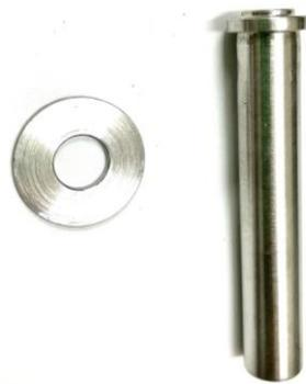
**Figura 1:** Matriz metálica e dispositivo metálico utilizados para confecção dos corpos-de-prova.
