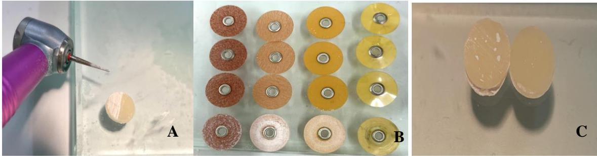
**Figura 2** - A - Acabamento das amostras com a ponta diamantada 3195F; B - Discos Sof-Lex Pop On (3M ESPE), utilizados para realização do polimento das amostras, variação de cor de acordo com suas devidas granulações; C - Diferença entre amostras com o polimento e sem o polimento.
