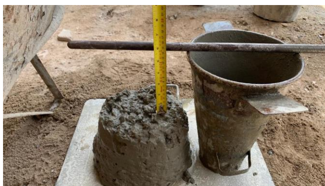
Figura 7 – Medição do abatimento do concreto
