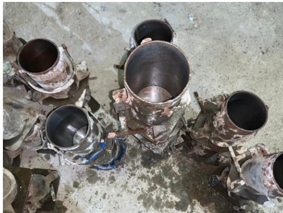
Figura 9 – Camada de óleo mineral no interior dos moldes
