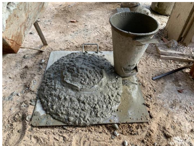
Figura 8 – Slump Test com valor elevado
