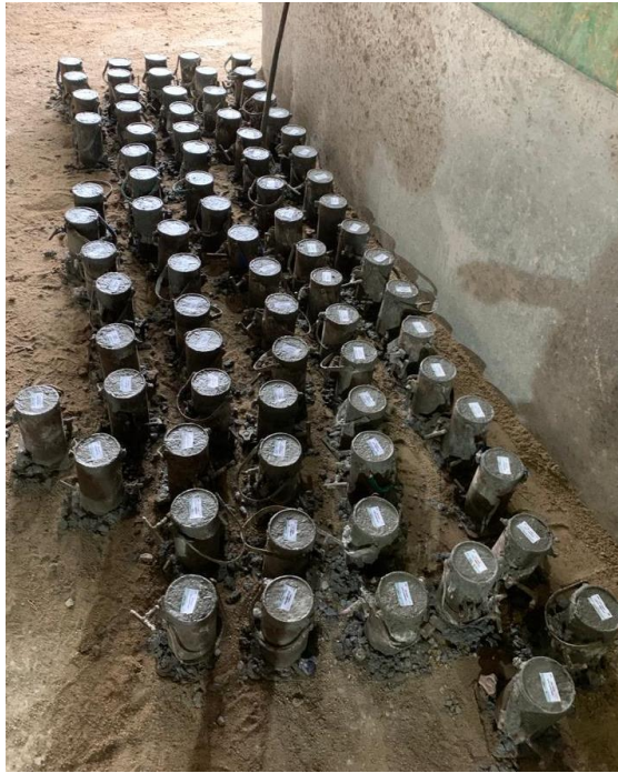
Figura 10 – CP's descobertos durante o período inicial de cura
