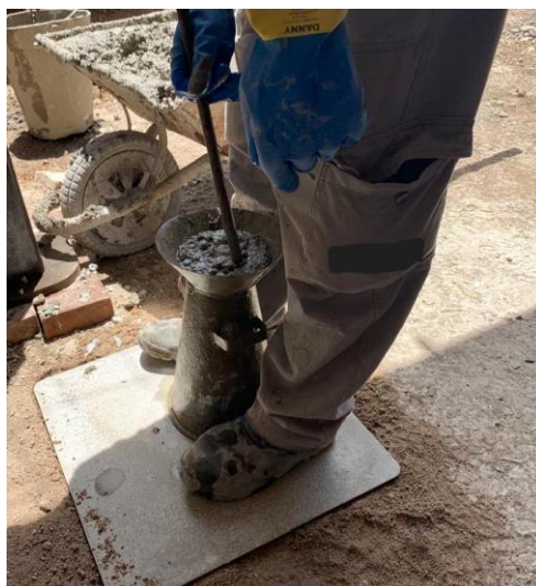
Figura 6 – Preenchimento do molde
