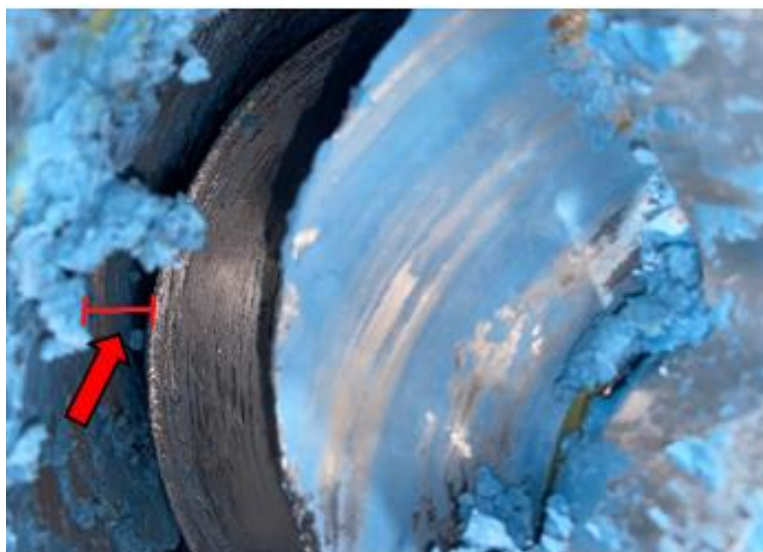
Figura 10. Folga entre a trefila e a parede protetora.
