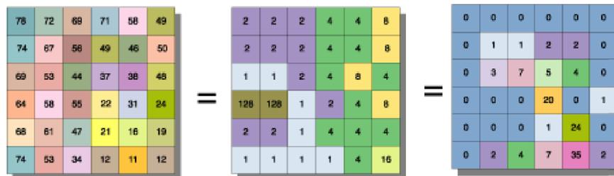
**Fonte:** Adaptado de Morais et al., 2013. **Legenda:** Imagem à esquerda = Representação das células de elevação; Imagem ao centro = Representação das células Flow Direction (direção de fluxo); Imagem a direita = Representação das células Flow accumulation (acúmulo de fluxo).
