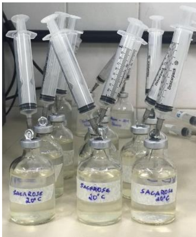
Figura 11 - Seringas acopladas aos reatores durante o processo fermentativo para captação de gás
