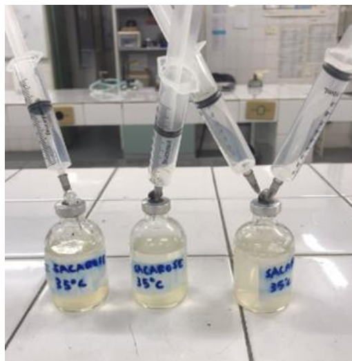
Figura 16 – Seringas acopladas aos reatores do sistema de 35°C após 21 dias de fermentação
