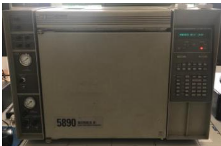
Figura 12 - Cromatógrafo Gasoso utilizado para as análises de biohidrogênio.
