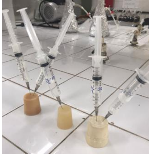
Figura 15 – Seringas retiradas dos reatores do sistema de 30°C após 21 dias de fermentação
