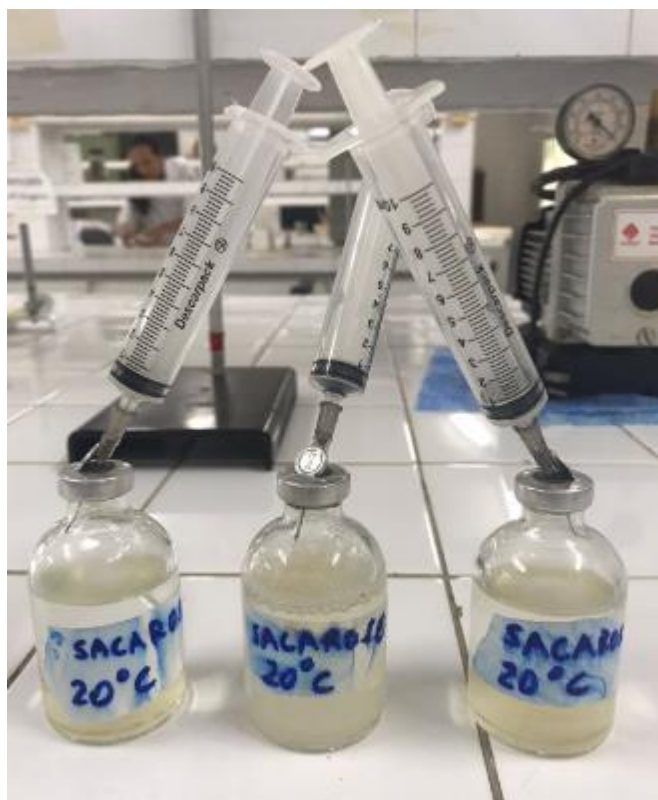
Figura 14 – Seringas acopladas aos reatores do sistema de 20°C após 21 dias de fermentação
