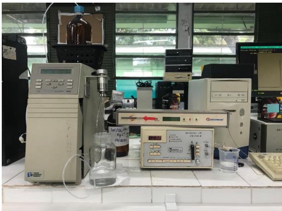
Figura 13 - Cromatógrafo líquido de alta eficiência (HPLC) utilizado para as análises de Etanol.
