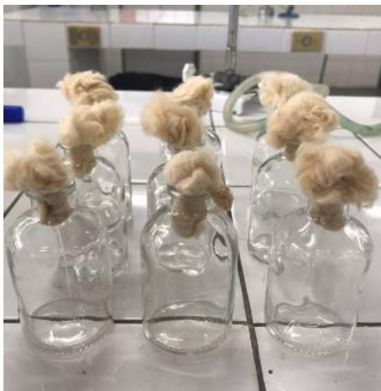
Figura 10 - Processo de tamponação para esterilização dos reatores utilizados na fermentação.
