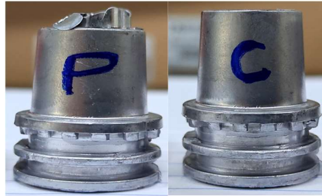
Figura 15 - Comparativo entre as buchas prensada e cortada.
