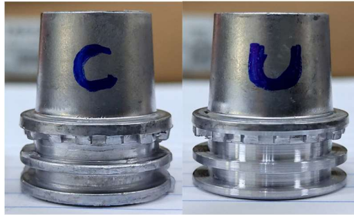
Figura 17 - Comparativo entre as buchas cortada e usinada.
