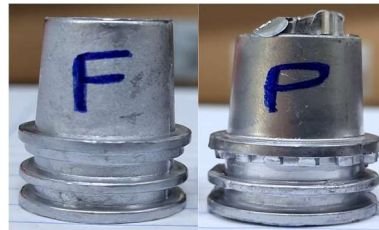
Figura 13 – Comparativo entre as buchas fundida e prensada.
