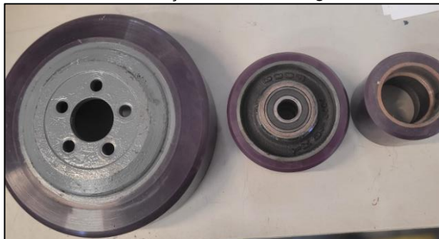
Figura 21 - Roda de tração, Roda de carga e Roda de apoio
