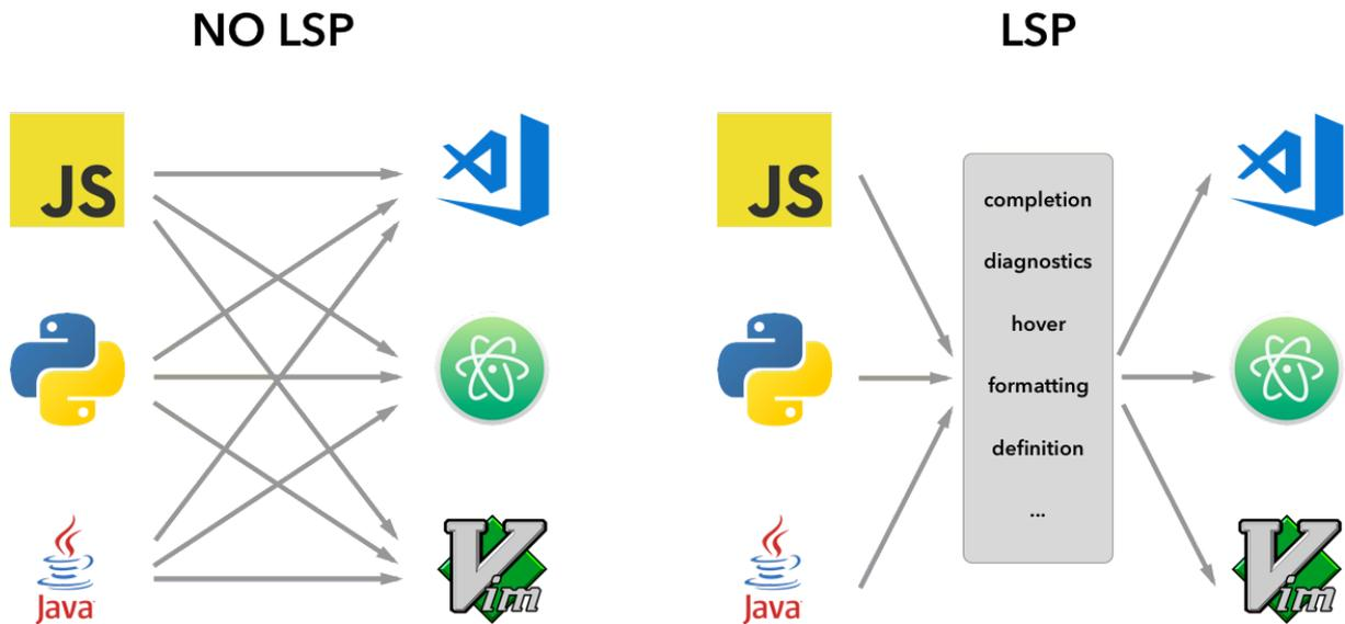
Figura 3: Diferença do funcionamento da implementação de *Language Servers* sem LSP e com LSP.
