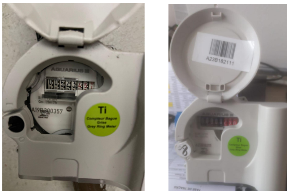
Figura 3: Hidrômetros da marca Aquarius com anel de transmissão por rádio frequência com diferenças na cor do background dos dígitos.
