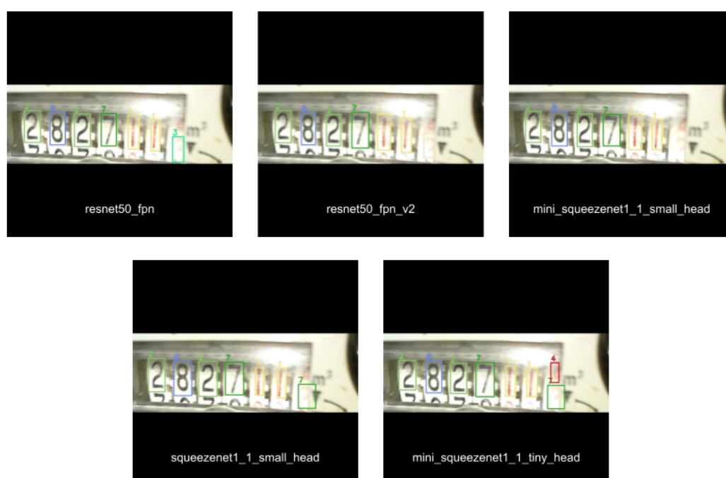
Figura 24: Um exemplo de resultado do teste de inferência aplicado com os 5 melhores modelos. Todos os dígitos visíveis foram detectados corretamente.
