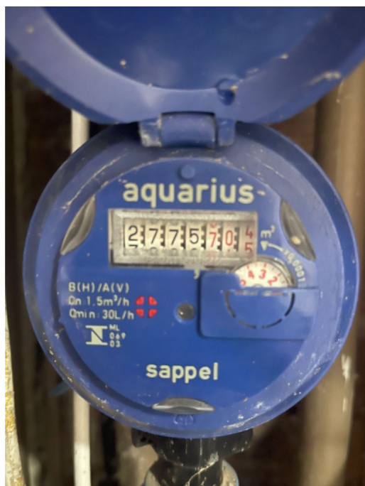
Figura 1: Direita: Hidrômetro Classe A Aquarius em plástico, com 5 dígitos inteiros pretos, 3 dígitos decimais vermelhos e background branco, sem equipamento para aquisição de dados via rádio-frequência e com catraca exposta. Esquerda: Hidrômetro Classe A Aquarius em plástico com 5 dígitos inteiros pretos, 3 dígitos decimais vermelhos e background branco com equipamento para aquisição de dados via rádio-frequência e com catraca exposta.
