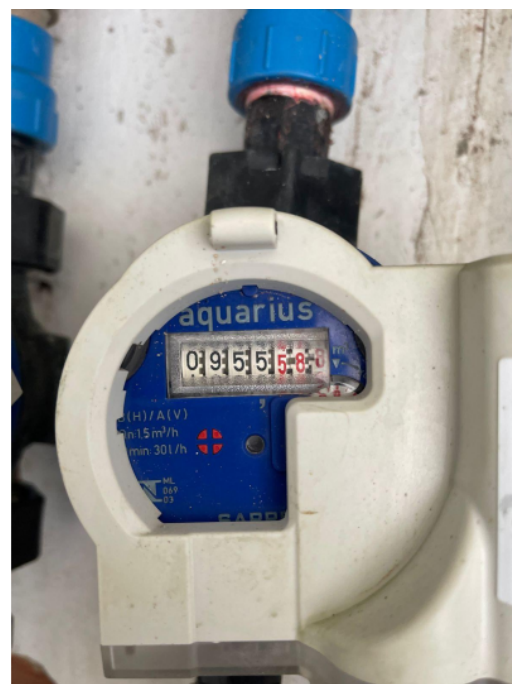
Figura 1: Direita: Hidrômetro Classe A Aquarius em plástico, com 5 dígitos inteiros pretos, 3 dígitos decimais vermelhos e background branco, sem equipamento para aquisição de dados via rádio-frequência e com catraca exposta. Esquerda: Hidrômetro Classe A Aquarius em plástico com 5 dígitos inteiros pretos, 3 dígitos decimais vermelhos e background branco com equipamento para aquisição de dados via rádio-frequência e com catraca exposta.
