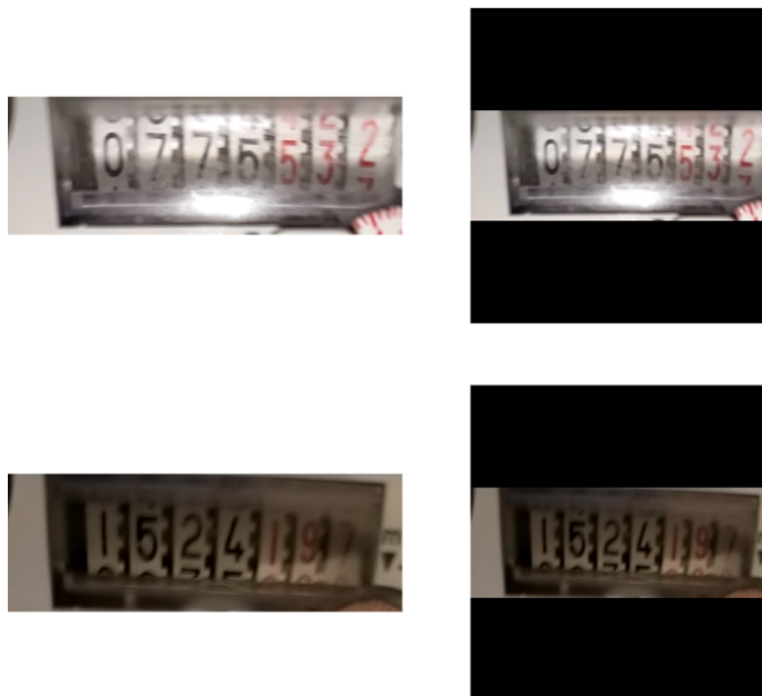
Figura 12: Imagens originais e após aplicação do zero-padding.
