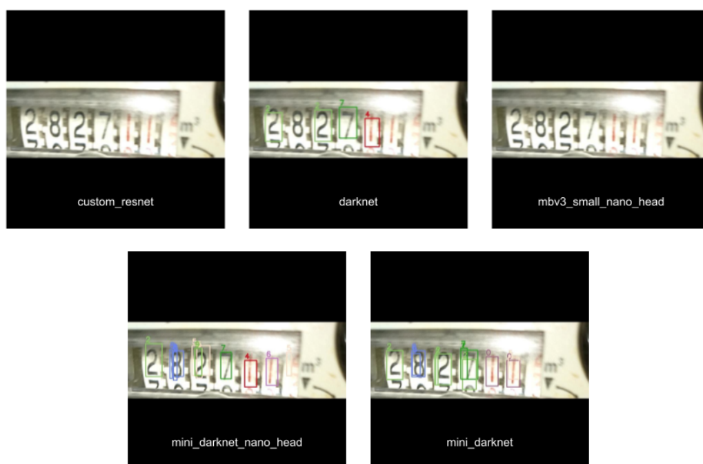
Figura 23: Um exemplo de resultado do teste de inferência aplicado com os 5 piores modelos. Dígitos visíveis não foram detectados, aconteceram detecções erradas ou múltiplas detecções no mesmo objeto.
