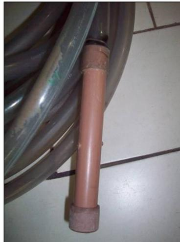
Figura 4.37 – Foto da mangueira, com válvula de retenção, utilizada no bombeamento de água nos poços de observação, no módulo experimental, Olinda –PE.
