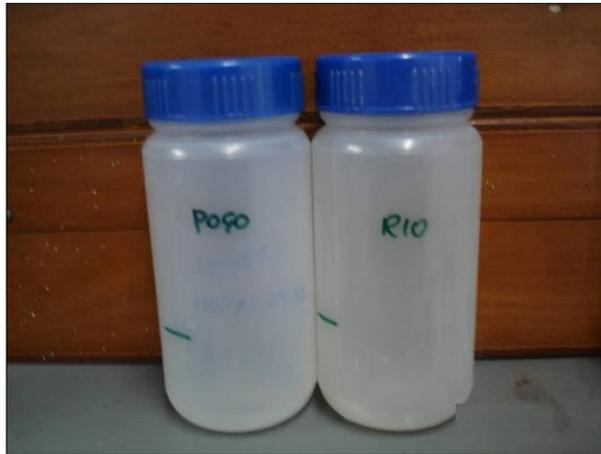
Figura 4.29 – Foto dos frascos autoclavados para coleta de água para análise de coliformes, na água do rio Beberibe e poço de produção, no módulo experimental, Olinda-PE.
