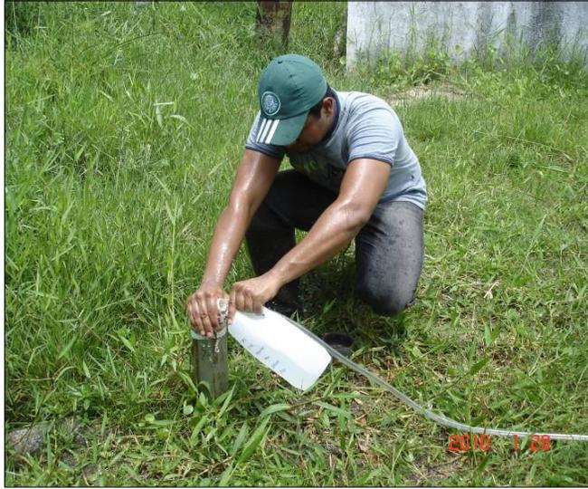
Figura 4.40 – Foto da coleta de água dos poços de observação, para análise de cianobactérias, no módulo experimental, Olinda –PE.
