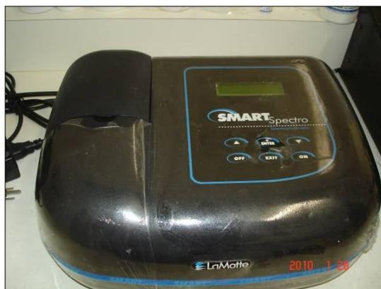
Figura 4.27 – Foto do espectrofotômetro Smart Spectro-La Motte utilizado na mensuração de alguns parâmetros físico-químicos, na água do rio Beberibe e poço de produção.
