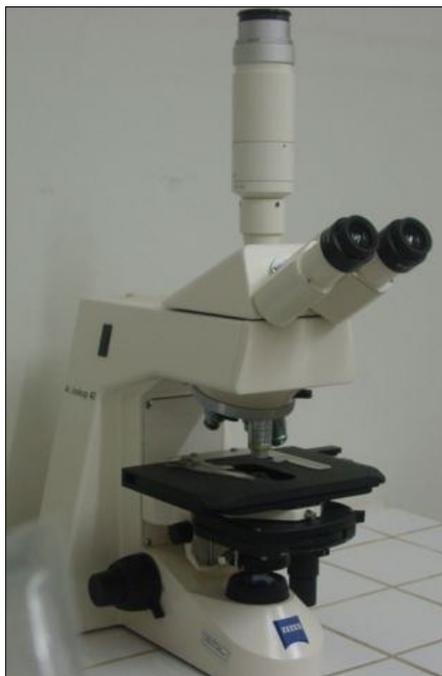
Figura 4.36 – Foto do microscópio óptico utilizado para fotografar as espécies mais abundantes do rio Beberibe, no módulo experimental de Olinda.
