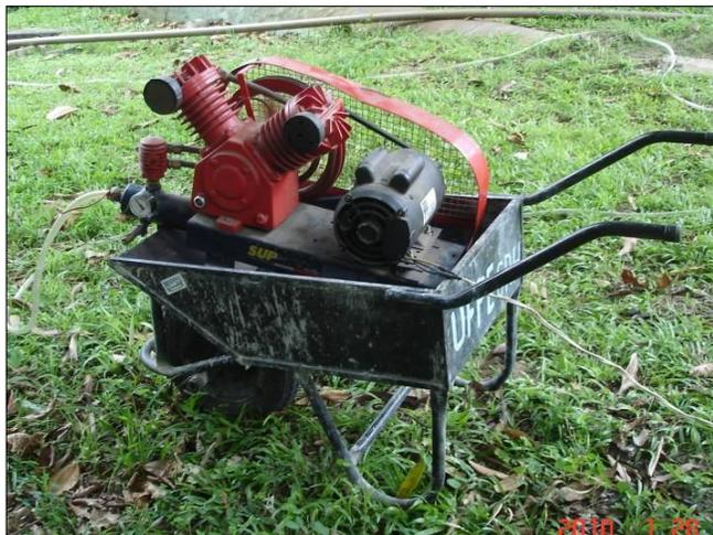
Figura 4.39 – Foto do compressor de ar utilizado para coleta de água nos poços de observação SP3 e SP8, no módulo experimental, Olinda –PE.
