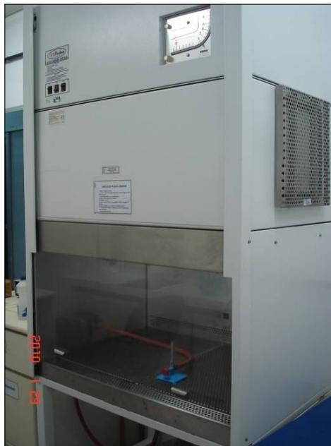
Figura 4.30 – Foto da capela de fluxo laminar e bico de Bunsen, utilizados nos procedimentos de análise de coliformes.
