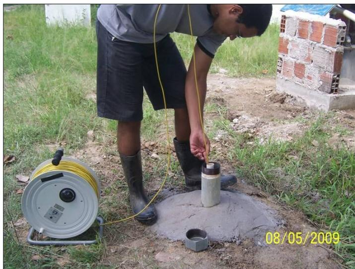
Figura 4.25 – Medição dos níveis piezométricos, no módulo experimental, Olinda-PE.
