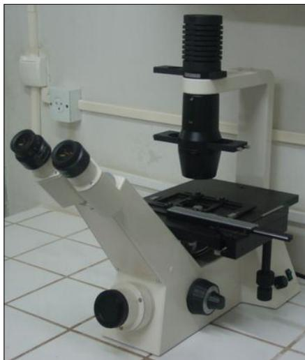
Figura 4.35 – Foto do microscópio invertido utilizado na contagem e identificação de cianobactérias.
