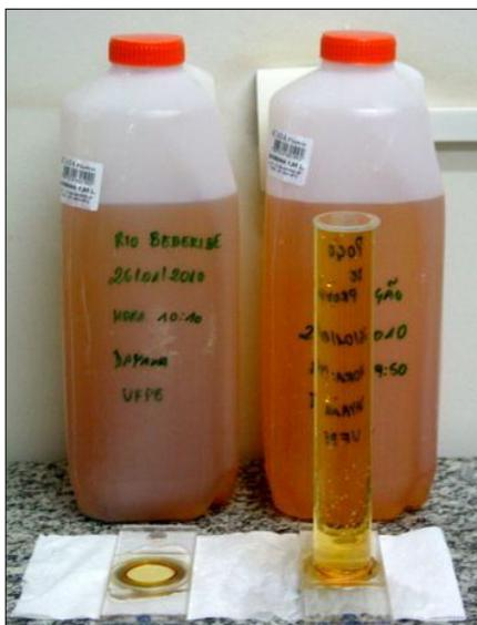
Figura 4.34 – Foto das amostras da água do rio Beberibe e poço de produção, fixadas em lugol acético, com alíquotas das mesmas nas câmaras de Utermöhl (1958), para sedimentação e posterior contagem e identificação.
