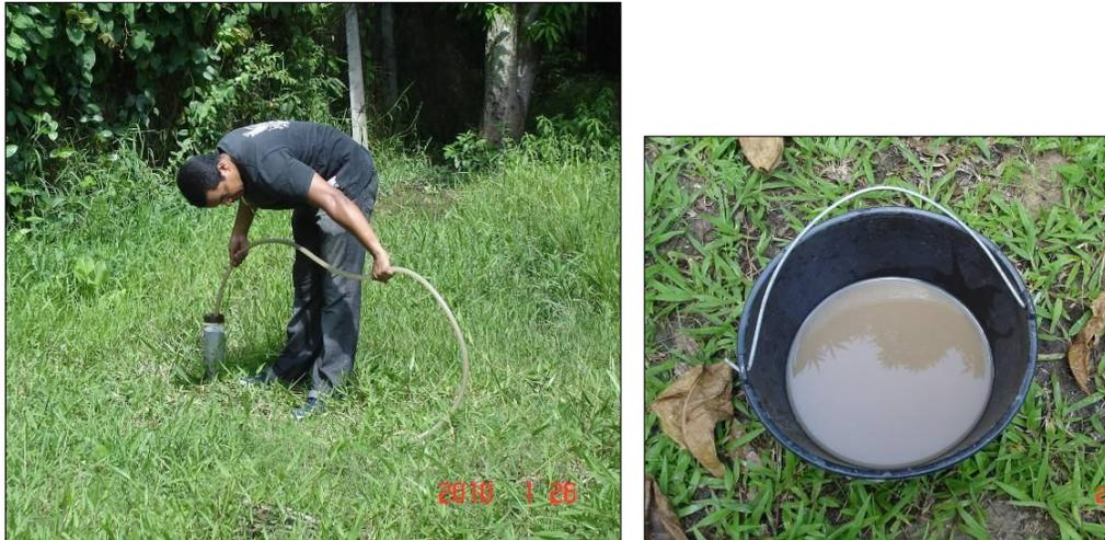
Figura 4.38 – Foto do bombeamento manual nos poços de observação, e aparência da água bombeada, no módulo experimental, Olinda –PE.
