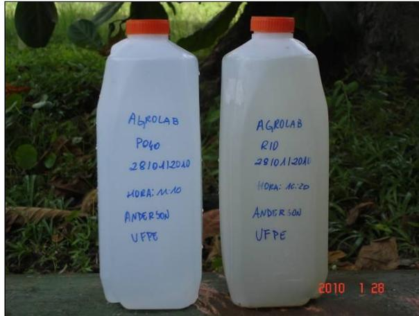
Figura 4.26 – Foto das amostras da água do rio Beberibe e água do poço de produção para análise físico-química.
