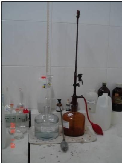
Figura 4.28 – Foto da bureta automática graduada de 50 mL, para medição da alcalinidade total em  $\text{CaCO}_3$ , na água do rio Beberibe e poço de produção.
