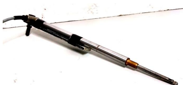
b) Defletoômetro elétrico indutivo (LVDT).
