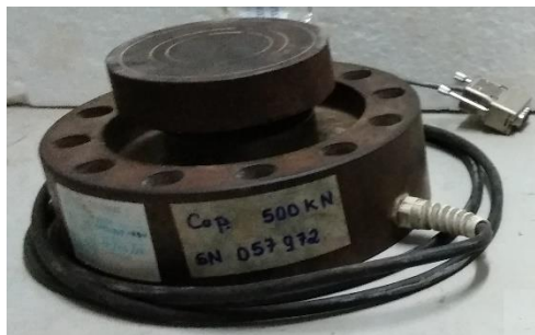
Foto 10 – Medidor de carga – célula de carga
