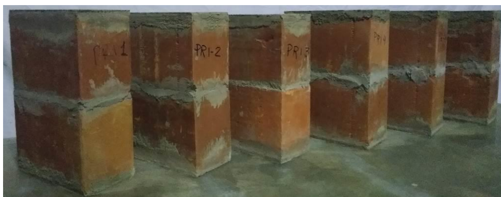
Foto 18 – Grupo de prismas para ensaio à compressão
