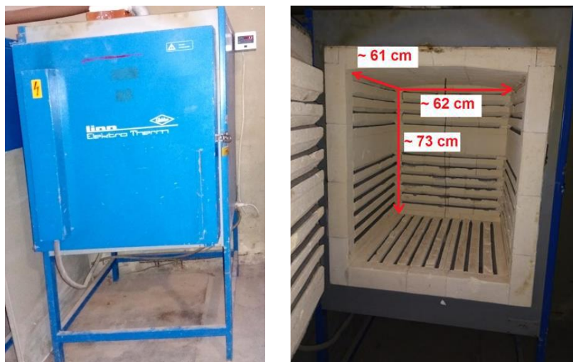
Foto 4 – Forno menor para ensaio térmico dos blocos e das argamassas
