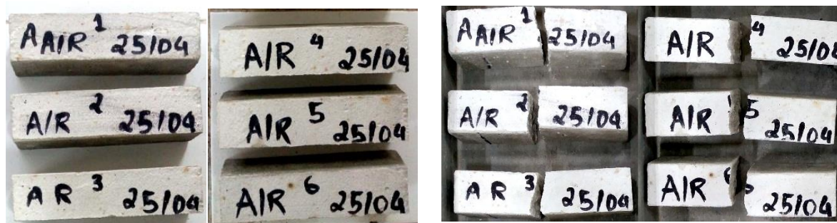
a) CP para ensaios à tração na flexão.
