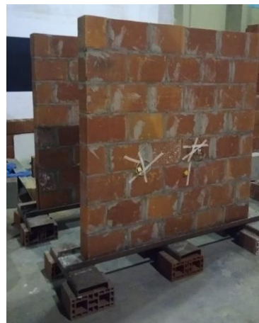
b) Parede com bloco estrutural.
