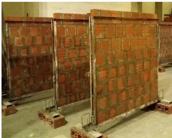
a) Parede com bloco comun.
