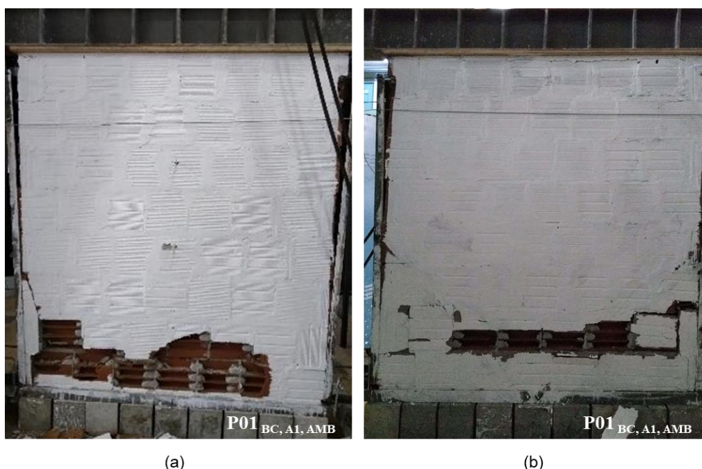
Foto 23 – Modo de falha da parede P01 BC, A1, AMB . (a) vista frontal e (b) vista posterior
