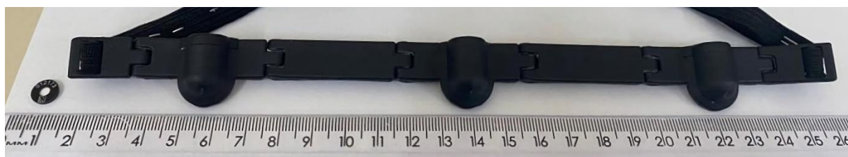
Figura 31 - Dosímetro EyeBand impresso com a técnica SLA
