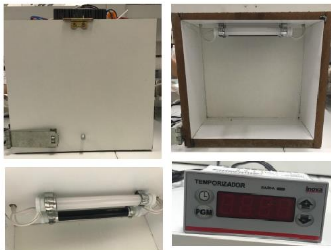
Figura 6 - Foto do equipamento simulador de irradiação UVA e UVB
