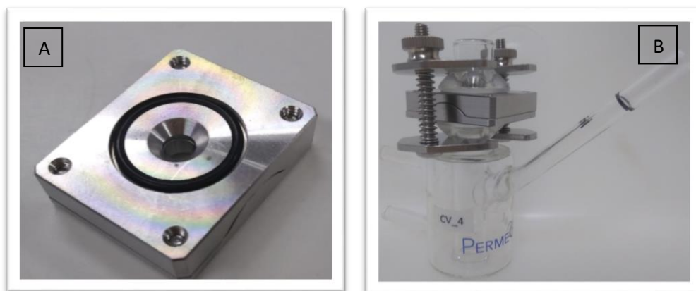
Figura 15 - Adaptador de unhas Permeagear® (A) e Célula de difusão de Franz vertical com o adaptador (B).
