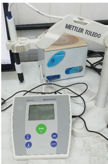
Figura 4 – pHmetro Mettler-Toledo utilizado nos experimentos de adsorção
