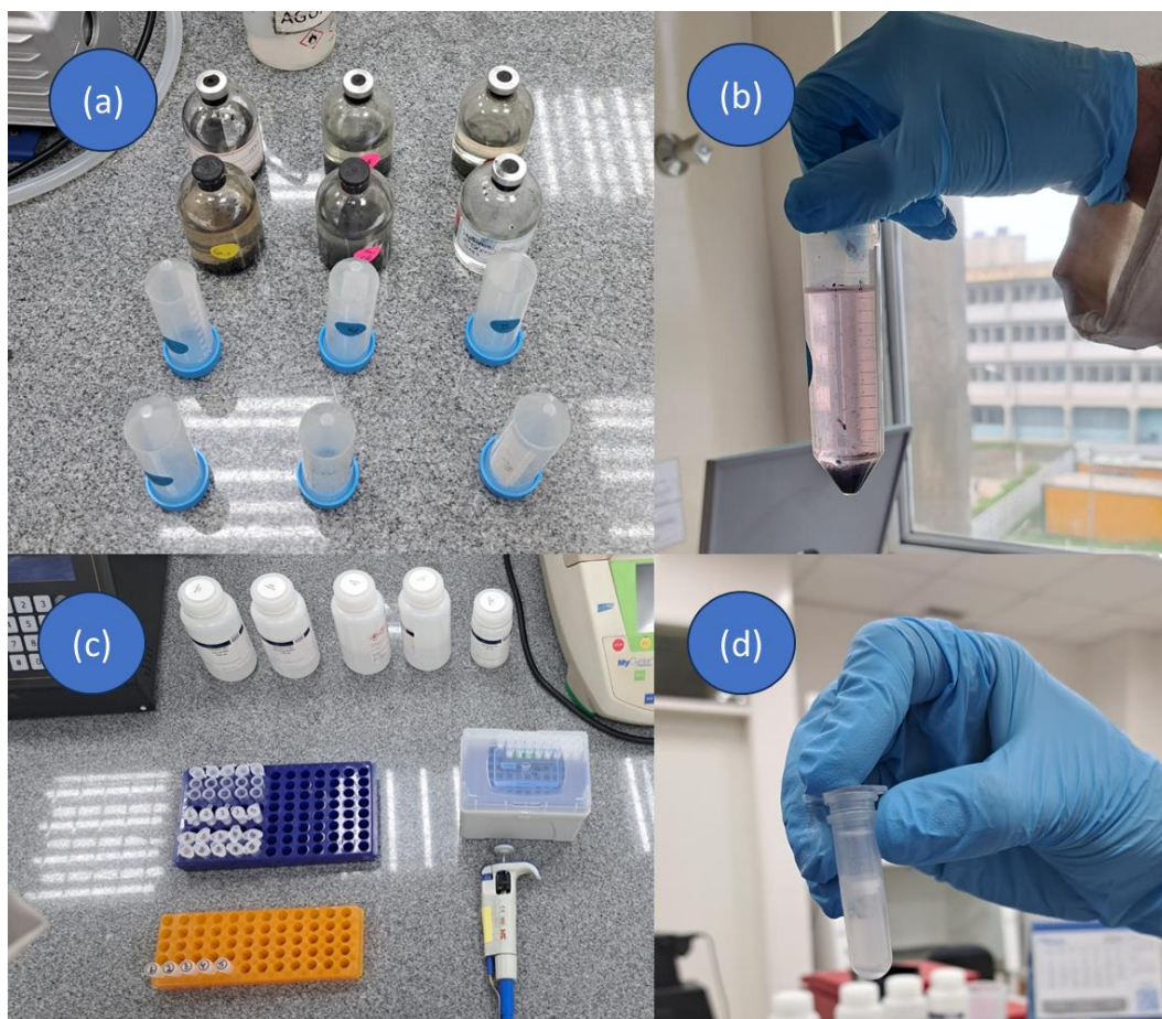
Figura 13 - (a) coleta da biomassa, (b) Tubo centrifugado, contendo pellet de biomassa e sobrenadante, (c) kit de extração de DNA, (d) Eppendorf, contendo DNA extraído
