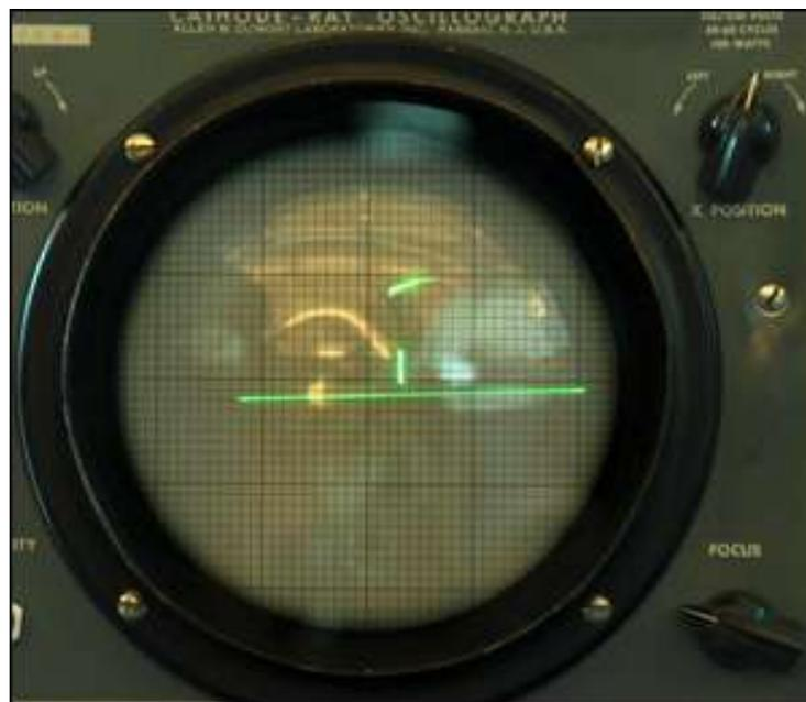
**Figura 4:** Recriação de *Tennis for Two* em um osciloscópio DuMont Lab tipo 304-A.
