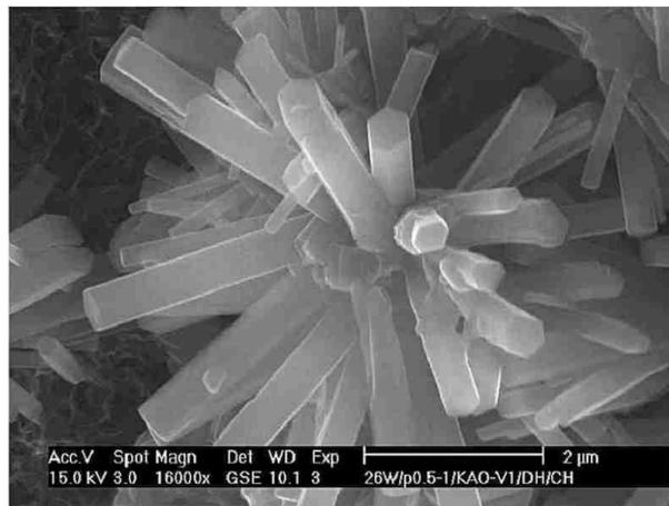
Figura 2.2. A etringita em forma acicular. Fonte: [http://www.uni-weimar.de/Bauing/fib/forschung/eng-fo\\_shz.htm](http://www.uni-weimar.de/Bauing/fib/forschung/eng-fo_shz.htm)
