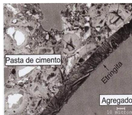
Figura 2.7b. Micrografia obtida por microscopia eletrônica de varredura de uma argamassa atacada por FET, (MEHTA e MONTEIRO, 2008)
