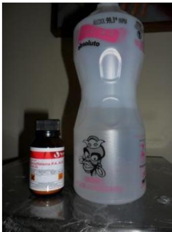
Figura 2.17. Fenolftaleína e álcool absoluto utilizados como ferramenta para reconhecer se o concreto está ou não carbonatado.
