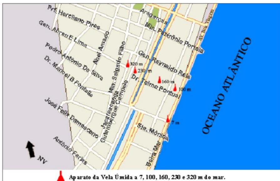
Figura 4.8. Zona de exposição do aparato de vela úmida (PONTES, 2006) em pontos distantes 7, 100, 160, 230 e 320 m do mar na RMR.
