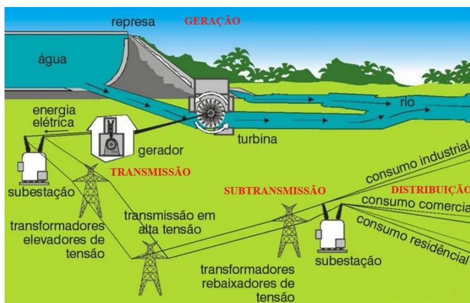
Figura 8 - Sistema Elétrico de Potência (SEP)
