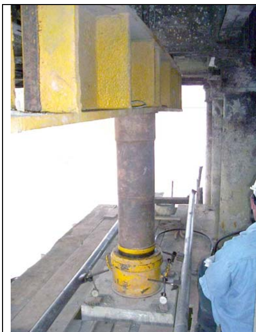
Figura 3.27 – Prova de carga estática vertical na estaca E3-BL7.
