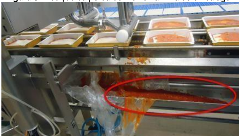
Figura 3. Medição da perda de molho na linha de embalagem
