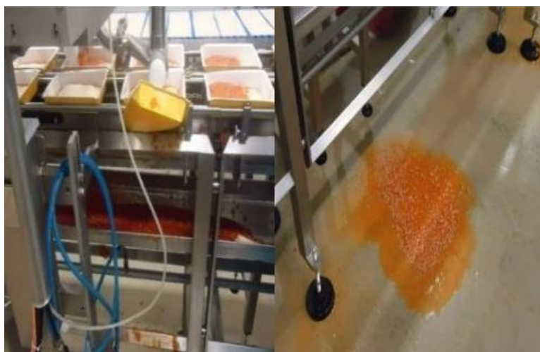
Figura 4. Perda de molho na calha e no chão
