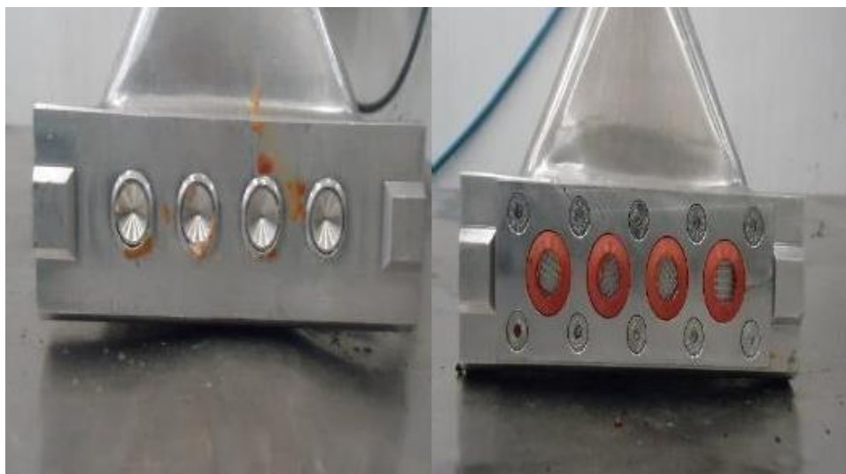
Figura 10. Sistema de vedação antes (esquerda) e depois (direita)
