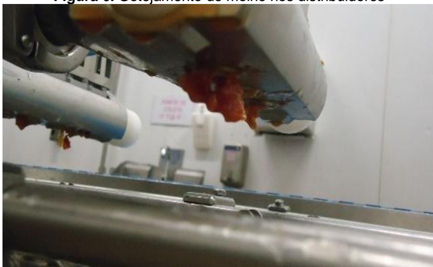
Figura 6. Gotejamento de molho nos distribuidores
