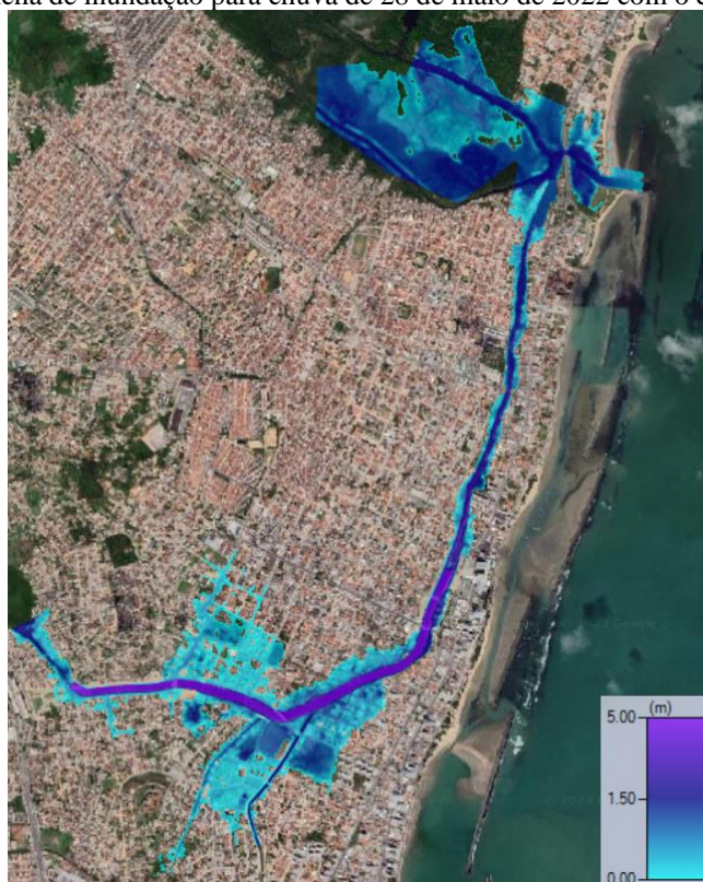
Figura 11 – Mancha de inundação para chuva de 28 de maio de 2022 com o canal inacabado
