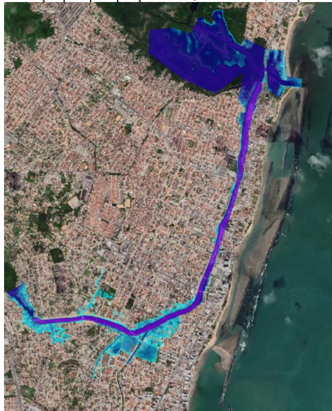
Figura 23 – Mancha de inundação para precipitação com T_r de 100 anos, duração de 3 t_c , e canal completo
