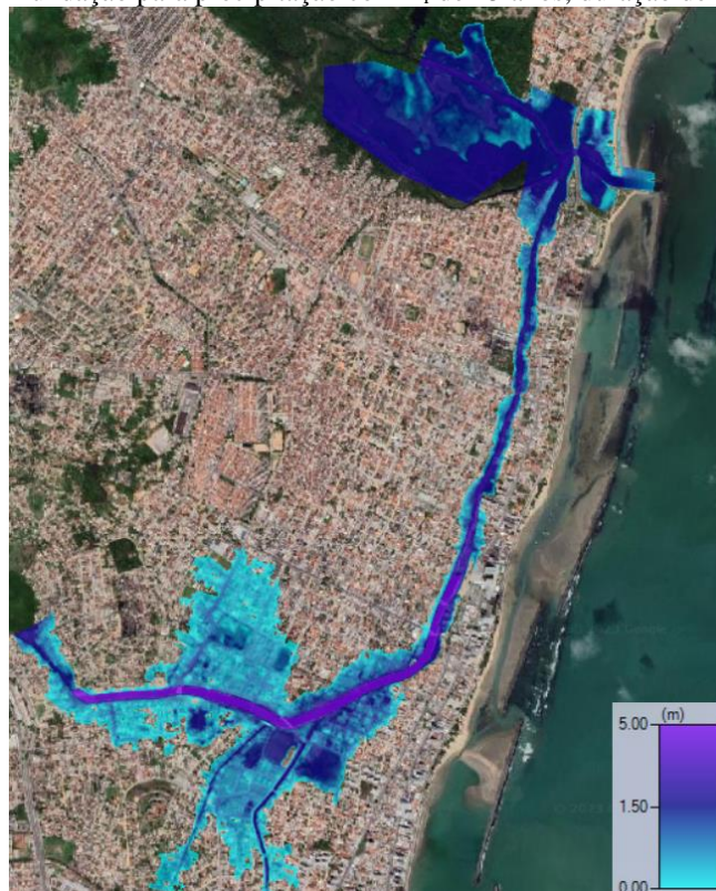
Figura 17 – Mancha de inundação para precipitação com T_r de 25 anos, duração de 6 t_c , e canal inacabado
