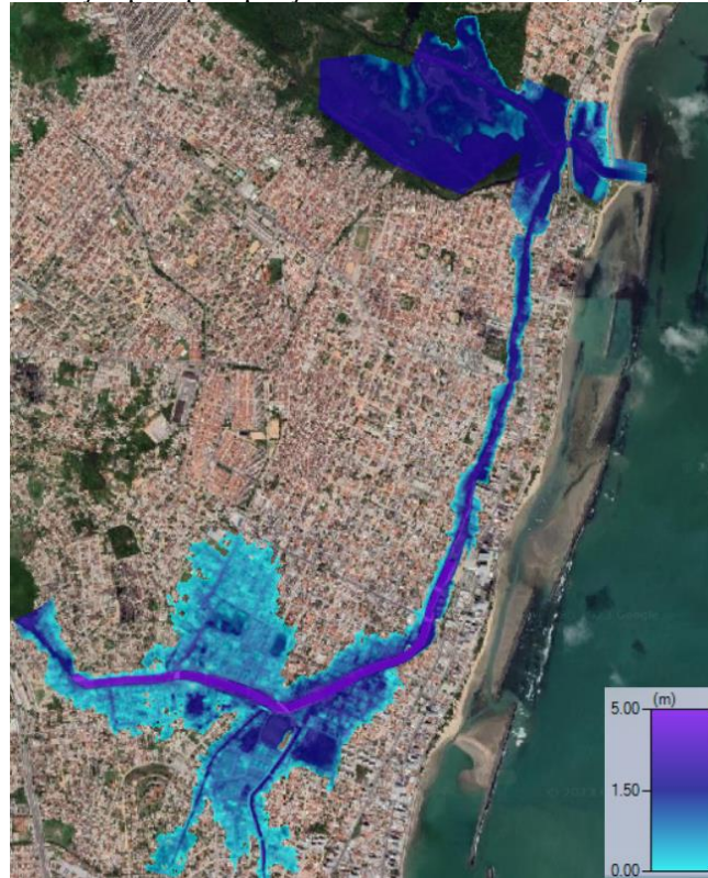
Figura 16 – Mancha de inundação para precipitação com T_r de 100 anos, duração de 3 t_c , e canal inacabado
