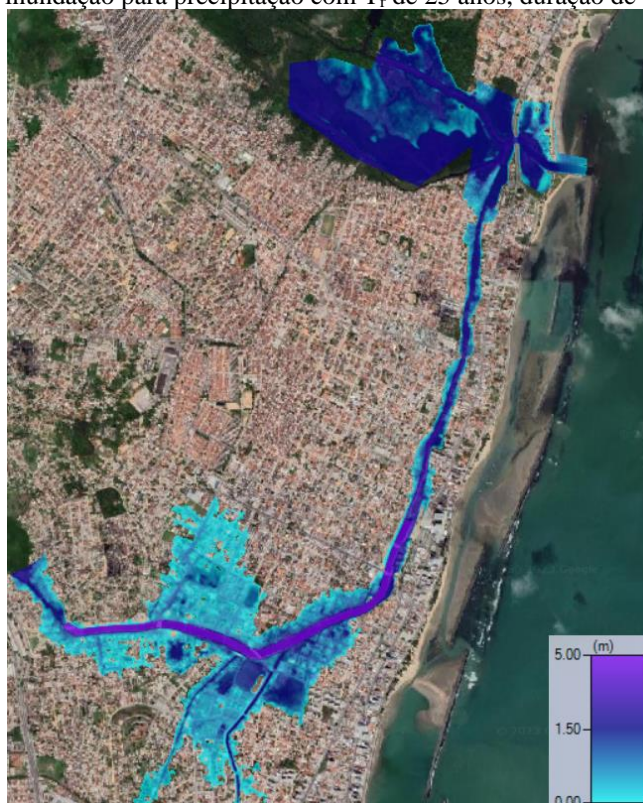
Figura 14 – Mancha de inundação para precipitação com T_r de 25 anos, duração de 3 t_c , e canal inacabado
