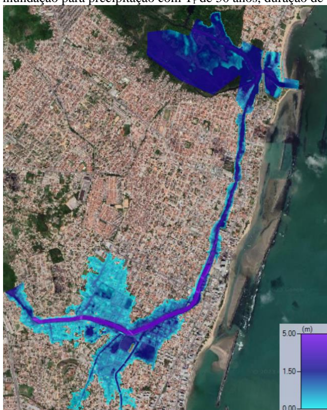
Figura 15 – Mancha de inundação para precipitação com T_r de 50 anos, duração de 3 t_c , e canal inacabado
