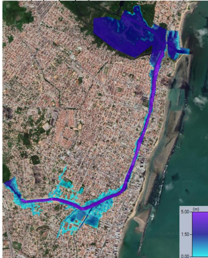
Figura 26 – Mancha de inundação para precipitação com T_r de 100 anos, duração de 6 t_c , e canal completo
