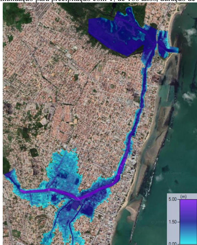
Figura 19 – Mancha de inundação para precipitação com T_r de 100 anos, duração de 6 t_c , e canal inacabado
