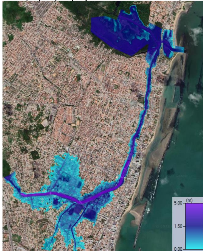
Figura 18 – Mancha de inundação para precipitação com T_r de 50 anos, duração de 6 t_c , e canal inacabado
