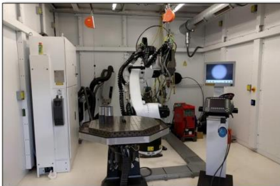
Figura 22 – Equipamento de soldagem HLAW do Firjan Senai/RJ
