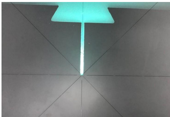
Figura 27 – Entalhe usinado para realização de pré-trincamento por fadiga
