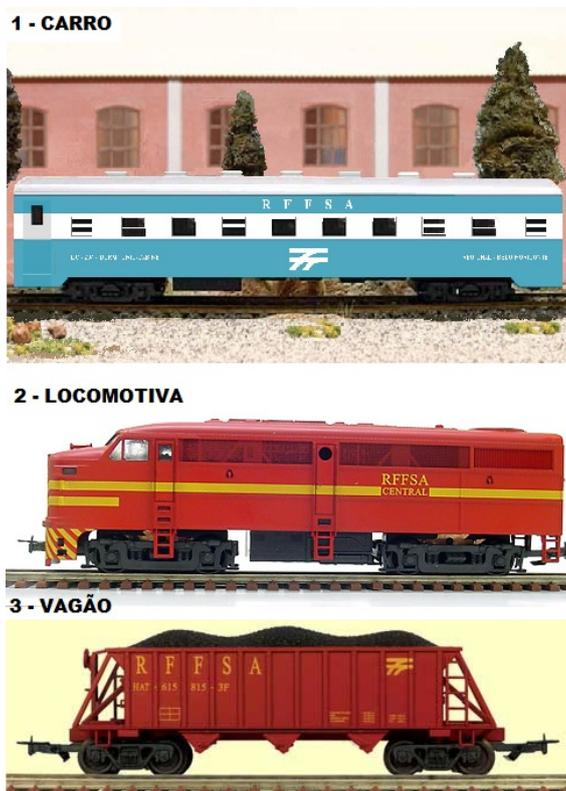
Figura 4.4 - Exemplo de material rodante em ferrovias de carga. Fonte: RFFSA/Arquivo pessoal
