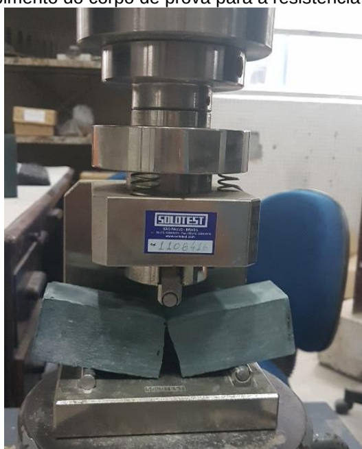
Figura 10 - Rompimento do corpo de prova para a resistência à tração na flexão
