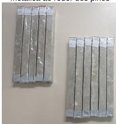
Figura 14 - Amostras de retração autógena embrulhadas com fita de empacotamento na lateral e fita metálica ao redor dos pinos
