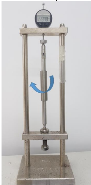
Figura 12 - Barra de referência encaixada no pórtico de retração com medidor digital
