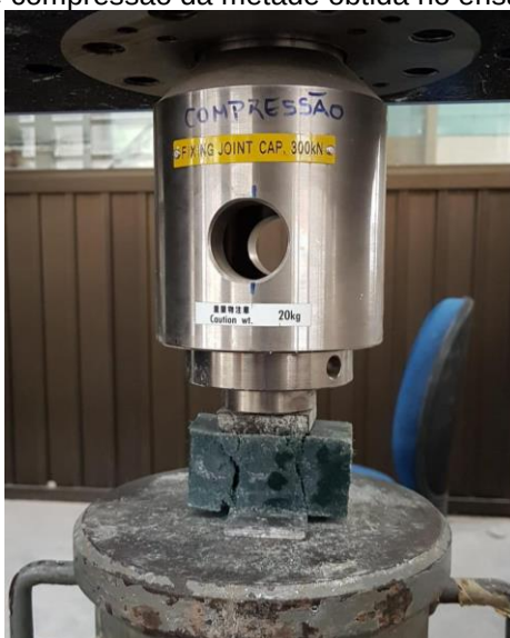
Figura 11 - Ensaio de compressão da metade obtida no ensaio de tração na flexão
