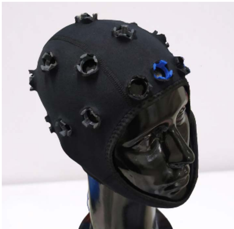
Figura 17 - Touca de neoprene com parte dos suportes de eletrodos fixadas de acordo com sistema 10-20
