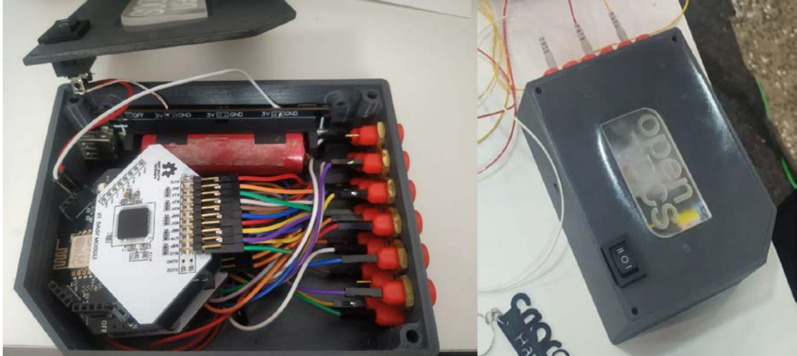
Figura 18 - Protótipo OpentDCS montado na CASE
