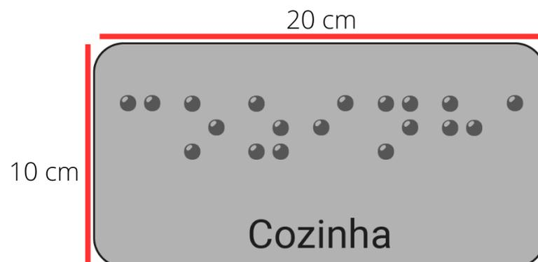
As placas serão independentes das placas formuladas com o layout desse projeto pois em uma possível troca, as placas em Braille feitas com alumínio permanecem atemporais. As medidas padrão são 20 cm x 10 cm pela norma NBR 9050.
