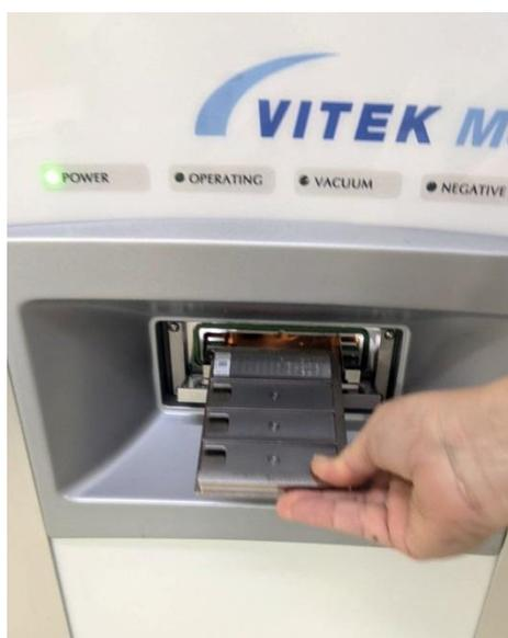
Os campos elétricos presentes no equipamento levam estes íons para o tubo de vácuo, que os separa de acordo com a massa das moléculas, resultando numa série de picos (espectro). Os espectros obtidos foram comparados com os espectros da base de dados de uma série de espécies bacterianas, sendo este o critério de identificação.
