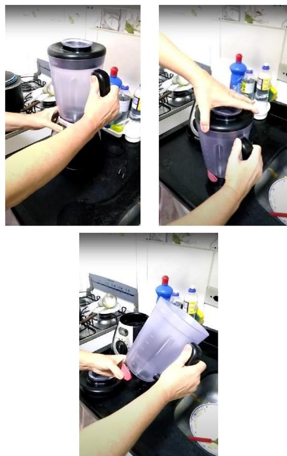
Figura 19 - Processo de desmontagem do produto A
