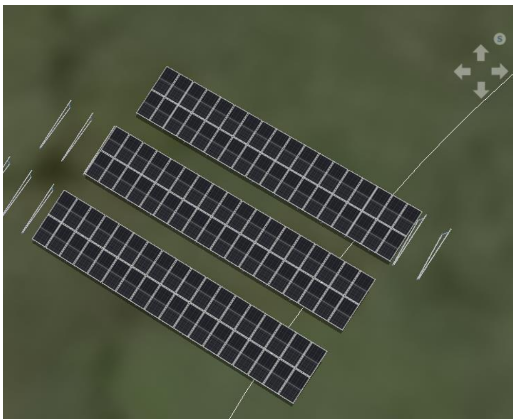
Figura 30 - Distribuição dos módulos fotovoltaicos - Topologia conceitual B
