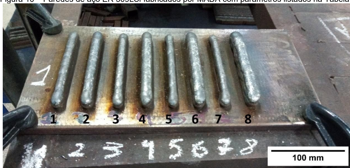
Figura 10 – Paredes de aço ER 309LSi fabricados por MADA com parâmetros listados na Tabela 5
