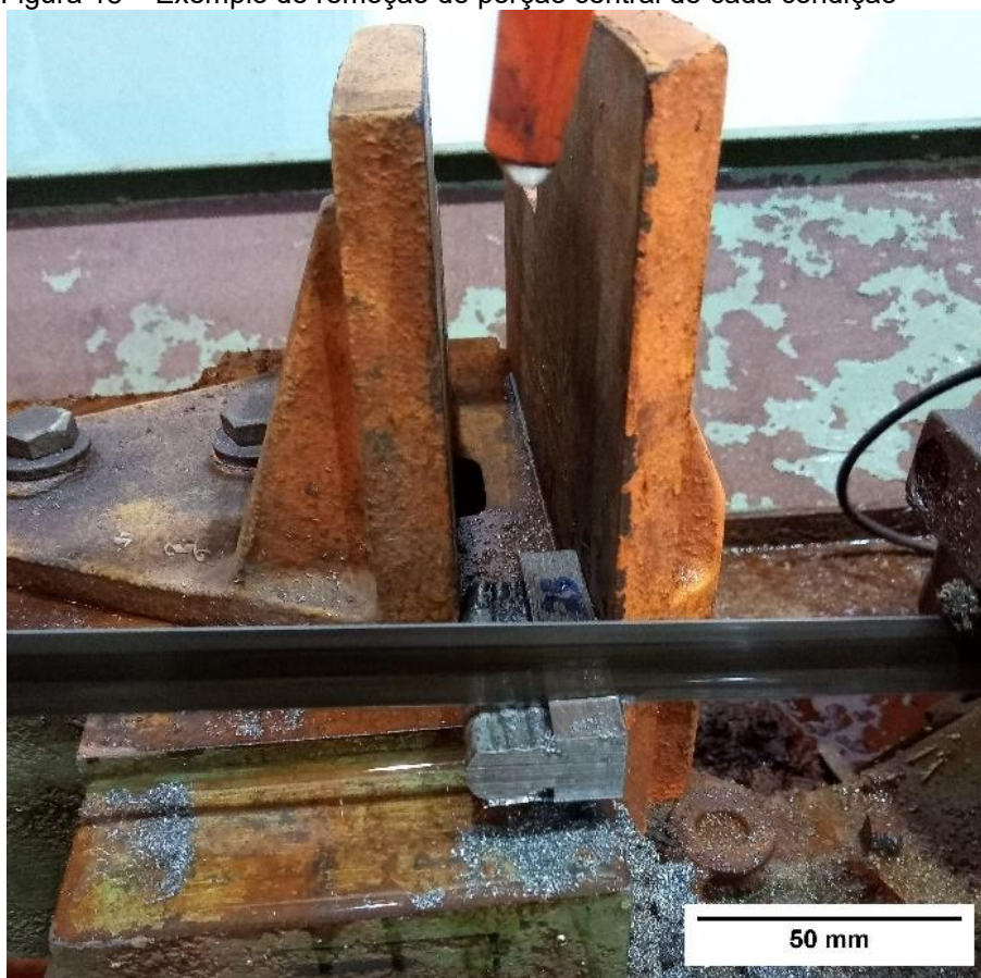
Figura 18 – Exemplo de remoção de porção central de cada condição
