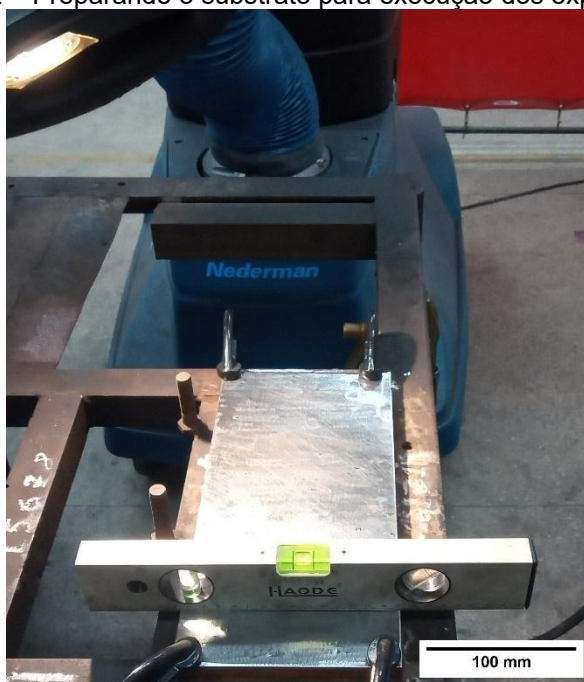
Figura 12 – Preparando o substrato para execução dos experimentos
