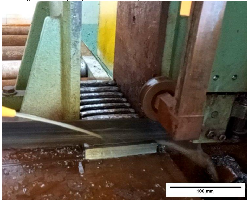
Figura 15 – Separação de cada condição experimental do substrato
