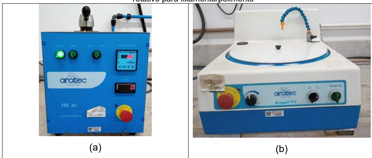
Figura 19 – Equipamentos para auxiliar na preparação das superfícies: (a) Embutidora; (b) suporte rotativo para lixamento/polimento
