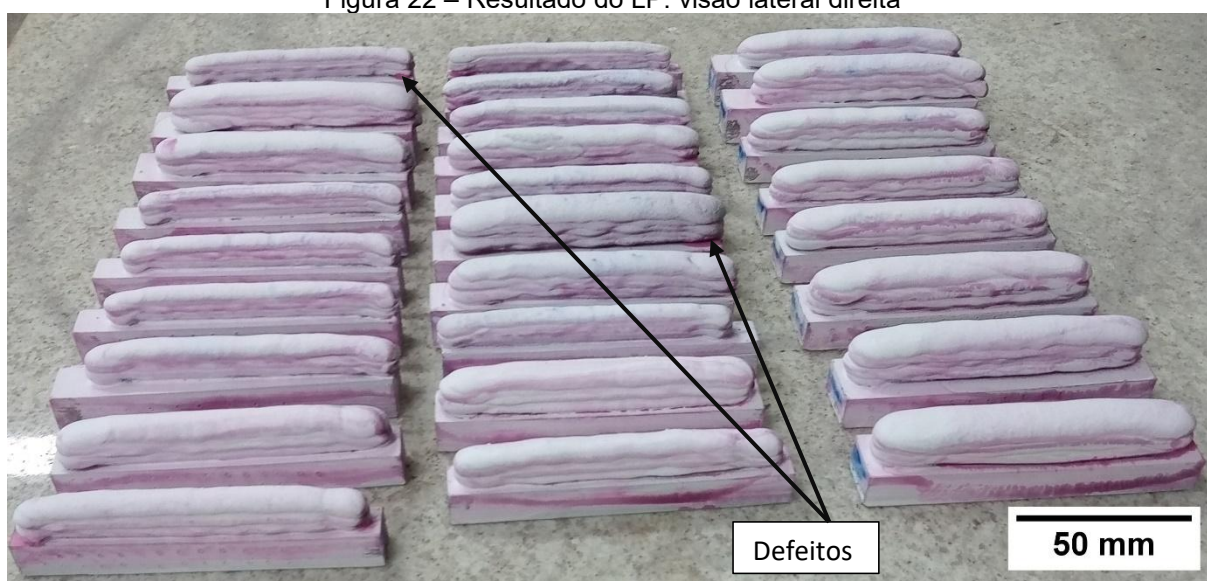
Figura 22 – Resultado do LP: visão lateral direita
