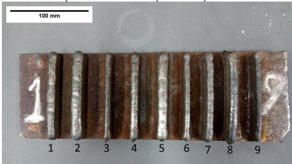
Figura 9 – Paredes de aço ER309LSi fabricados por MA com parâmetros listados na Tabela 4
