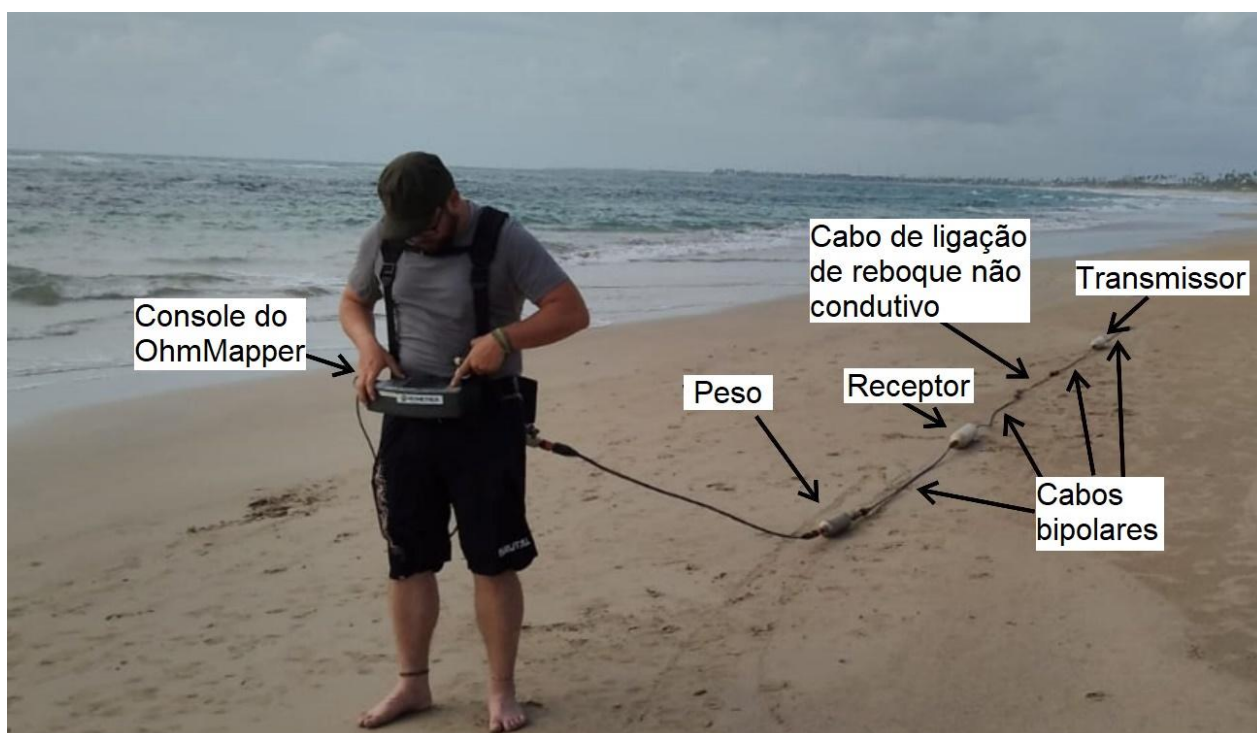
Figura 27 - Sistema OhmMapper (Geometrics Inc), que é composto pelo transmissor e receptores, além do data logger, utilizado para fazer o levantamento geofísico na Praia de Paiva, em dezembro de 2021.
