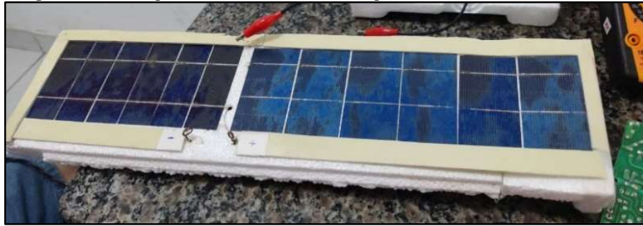
Figura 25- Protótipo Híbrido Utilizando Diodo para Direcionar a Corrente Elétrica
