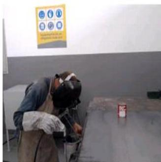
Foto I: Simulação de acidente mostrada a proximidade da lata de tinta (inflamável) e a não utilização de alguns EPI's.
