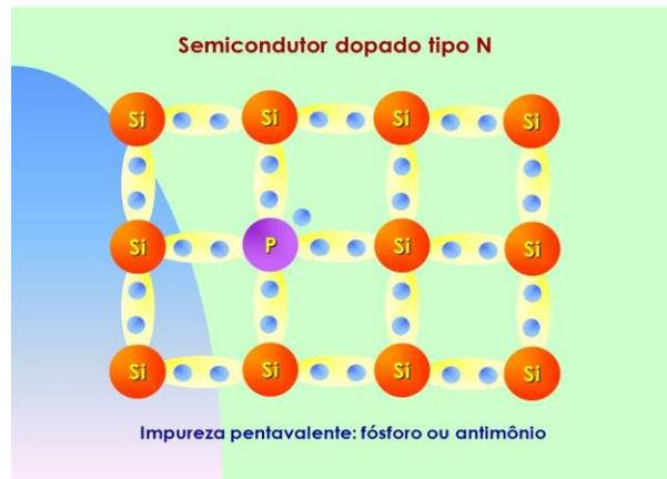
Figura 8 – Representação bidimensional do cristal de silício dopado com fósforo. Fonte: [https://slideplayer.com.br\(2019\)](https://slideplayer.com.br(2019))
