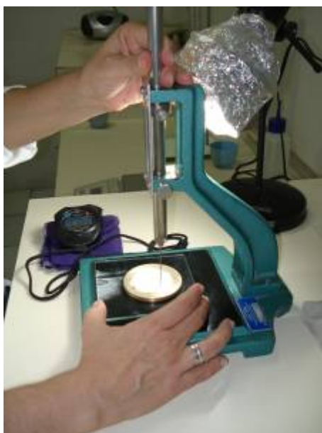
FIGURA 10 – Aparelho de Vicat – Ensaio de tempo de pega.
