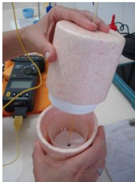
FIGURA 9 – Detalhe do sistema adiabático
