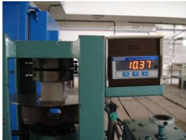
FIGURA 15 – Rompimento do corpo de prova em prensa hidráulica.
